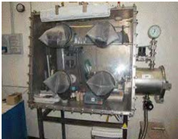
Scatola a guanti in atmosfera controllata
