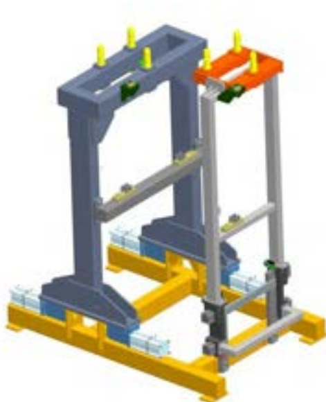
Fig. 8 Struttura di stoccaggio sistemi di presa
