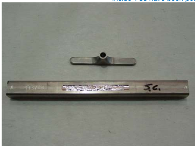
Fig.6 - Test preliminare per controllo delle temperature: inserto He inlet saldato su campione di conduttore 22x26 mm All'interno sono state posizionate le termocoppie sec. lo schema di Fig.2
