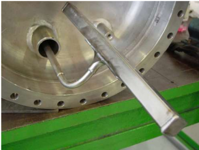
Fig. 11.1 – 11.2 - Test in pressione e di tenuta a vuoto / Pressure and He leak test
