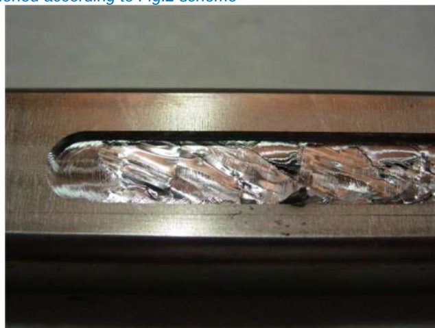
Fig.6 - Test preliminare per controllo delle temperature: inserto He inlet saldato su campione di conduttore 22x26 mm All'interno sono state posizionate le termocoppie sec. lo schema di Fig.2
