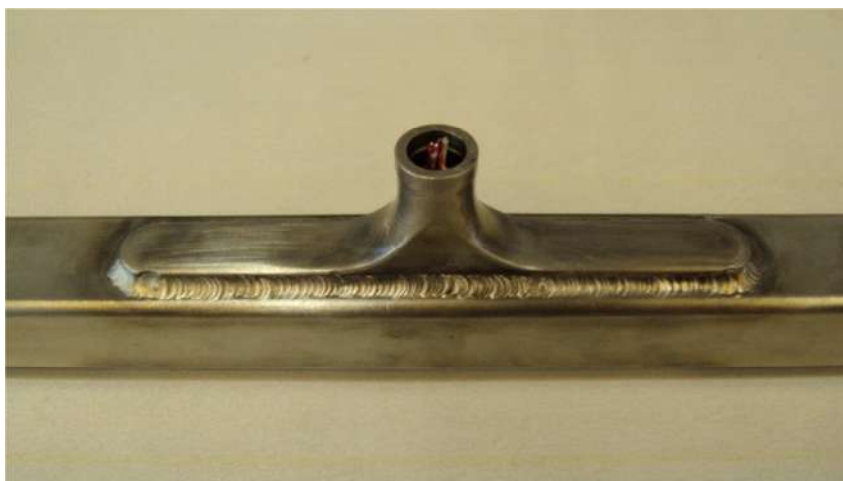
Fig.6 - Test preliminare per controllo delle temperature: inserto He inlet saldato su campione di conduttore 22x26 mm All'interno sono state posizionate le termocoppie sec. lo schema di Fig.2
