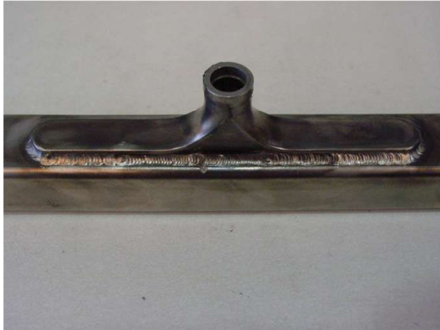
Fig.8 - Campione di qualifica / Welding qualification sample
