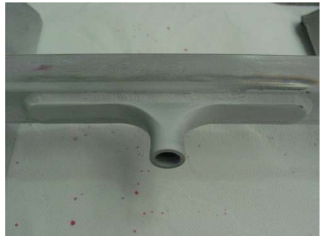
Fig.8 - Campione di qualifica / Welding qualification sample
