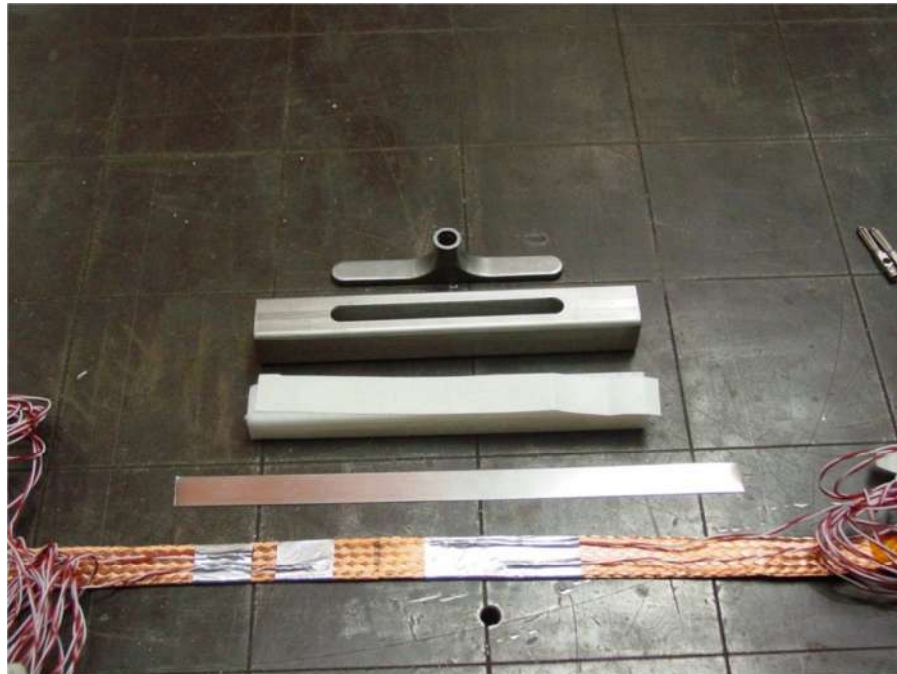
Fig.3 - Componenti per test preliminare: inserto ingresso He, tubo 25x25mm, riempitivo in nylon, lamierino sp=0.02mm, treccia in Cu con termocoppie Components for preliminary test: He inlet, 25x25mm tube, filler, s.s. shim th=0.02mm, Cu cable with thermocouples
