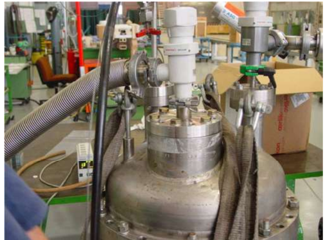
Fig. 11.1 – 11.2 - Test in pressione e di tenuta a vuoto / Pressure and He leak test
