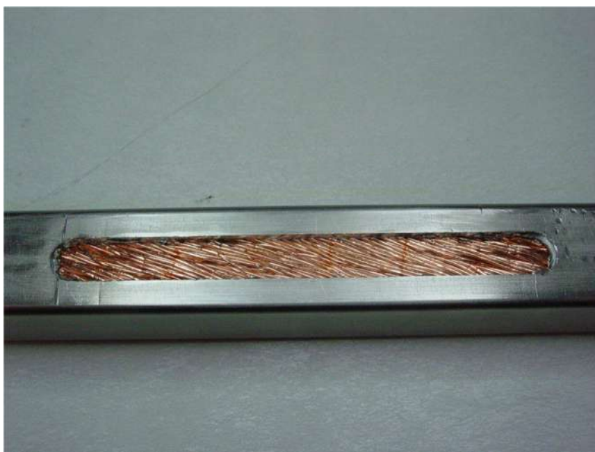
Fig.4 - Lavorazione meccanica del jacket / Machining of the jacket
