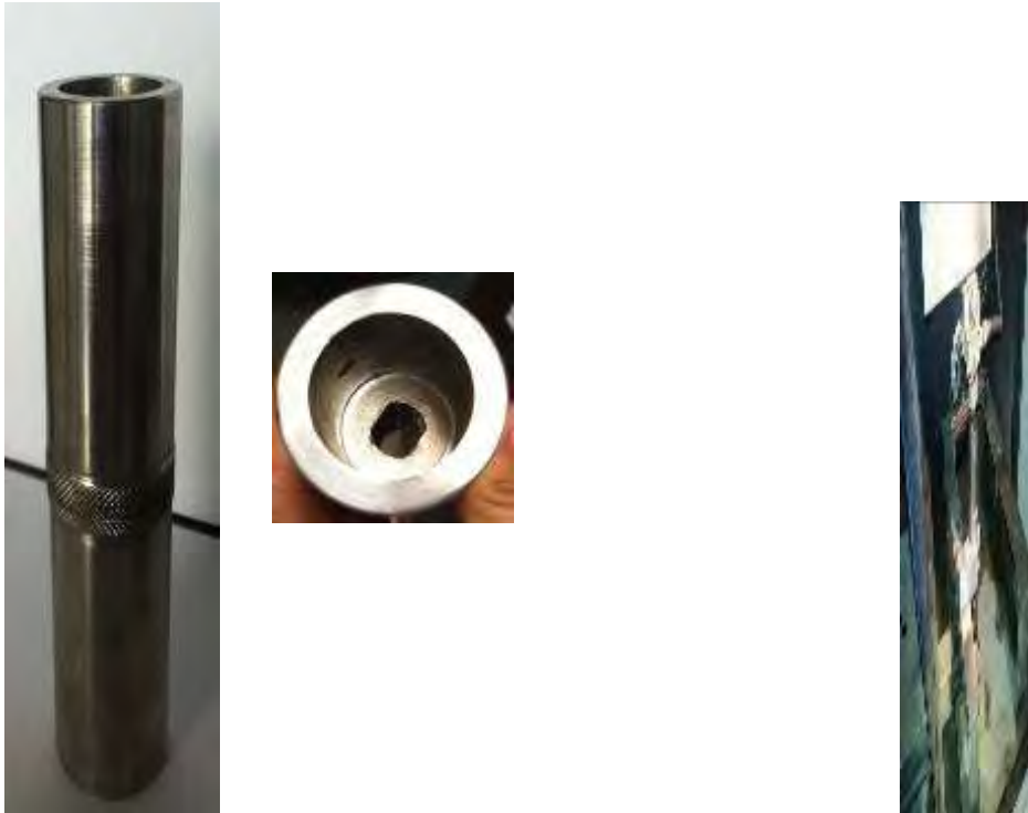
Figura 7 – particolare 5 in acciaio AISI 316 e lavorazione meccanica con elettroerosione a filo
