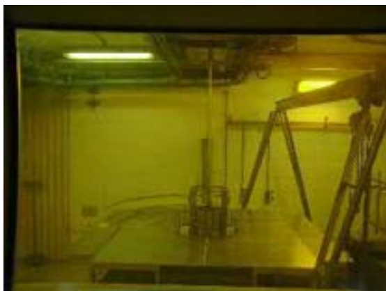
Figura 19 - Piattaforma d'acciaio posta in corrispondenza della piscina e dettaglio di un arco portadosimetri.
