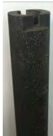
Figura 6 – particolari lavorazioni tubo di SiC
