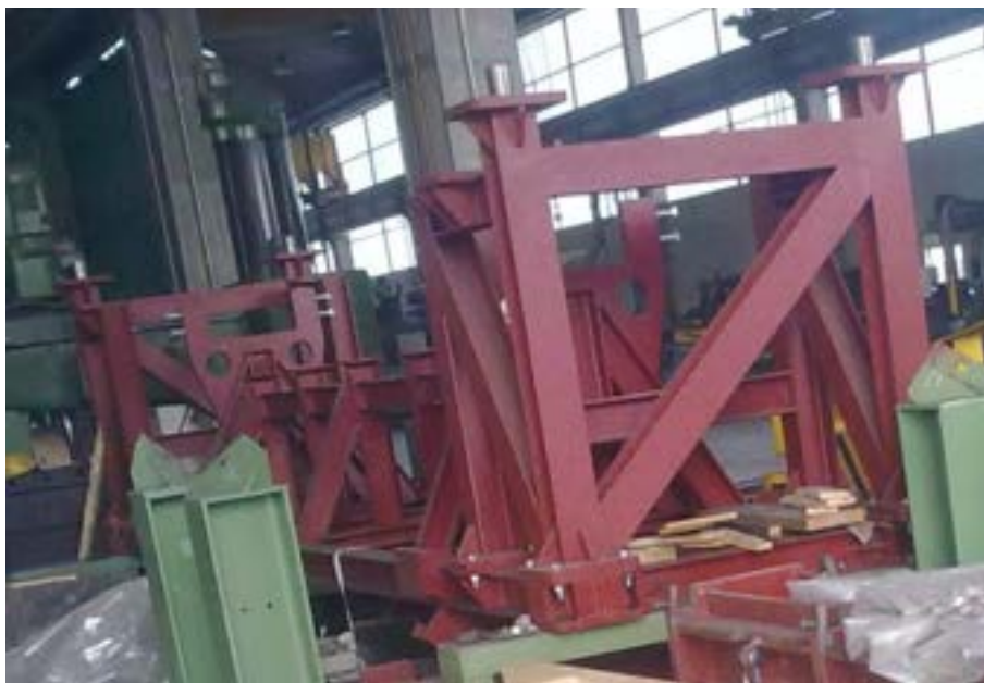
Figura 4: Attrezzature per la composizione della gamba dritta
