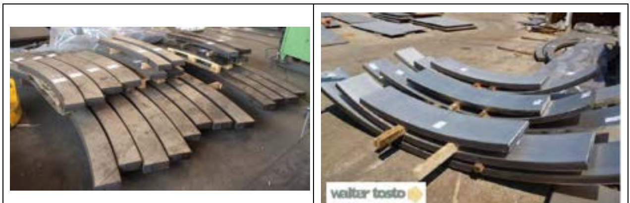
Figura 13: Componenti delle ali e basi delle gambe curve
