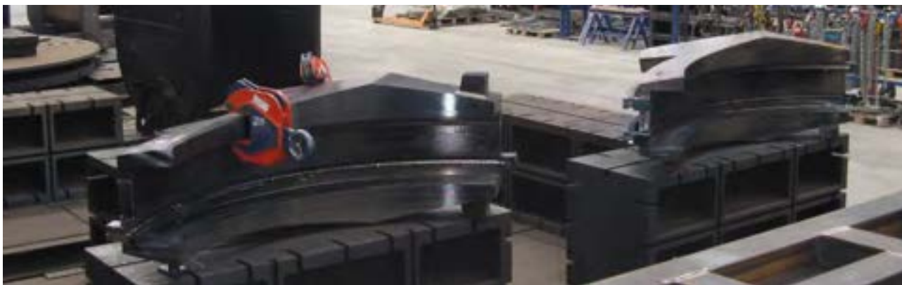
Figura 1: Gomiti della gamba dritta in materiale forgiato.
