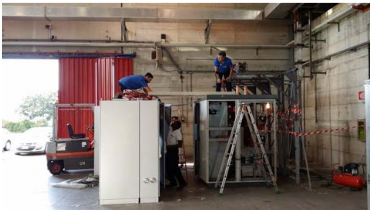
Figura 33. Preparazione delle prove nella Sala Convertitori del Centro Ricerche ENEA di Frascati. Le barre sulla destra, costruite appositamente per le prove sul prototipo riproducendo le barre di JT-60SA, provengono dal circuito di alimentazione di FTU.
