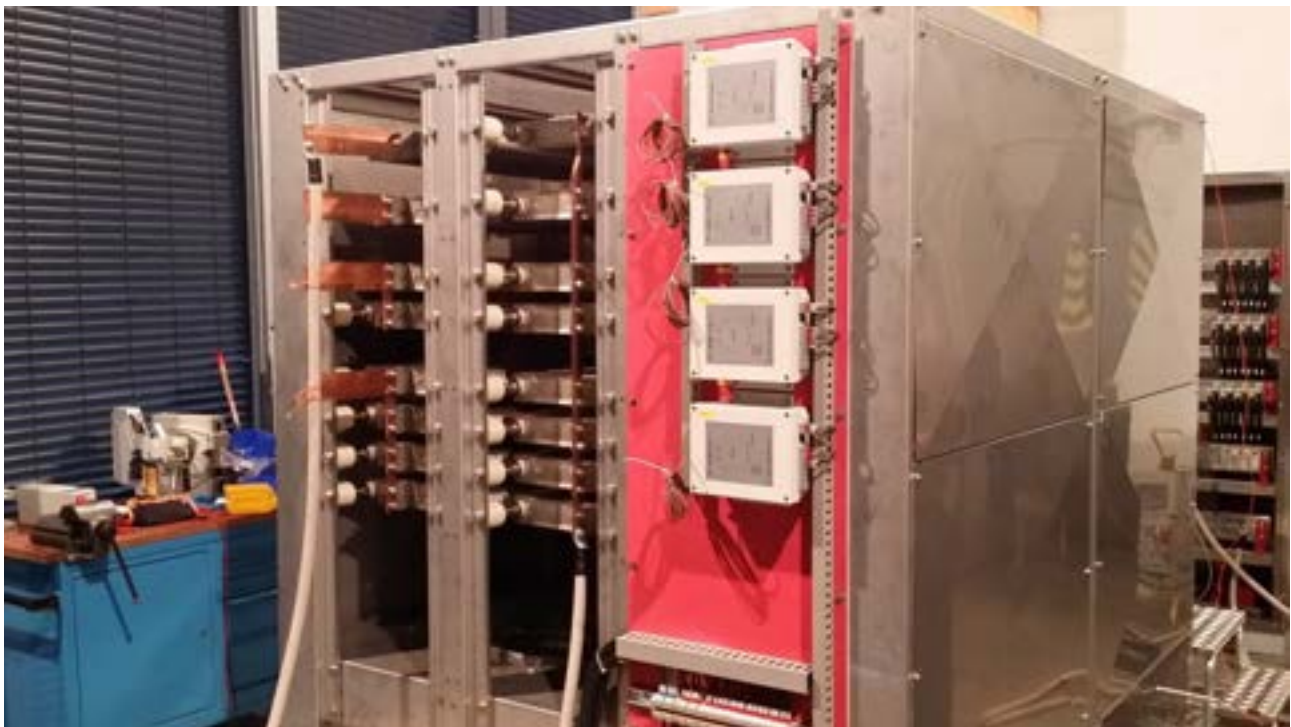
Figura 23. L'armadio del banco R1 durante un temperature rise test. Si notano i cavi provenienti dall'alimentatore AC/DC che sollecitano l'elemento più in alto del banco (R14).
