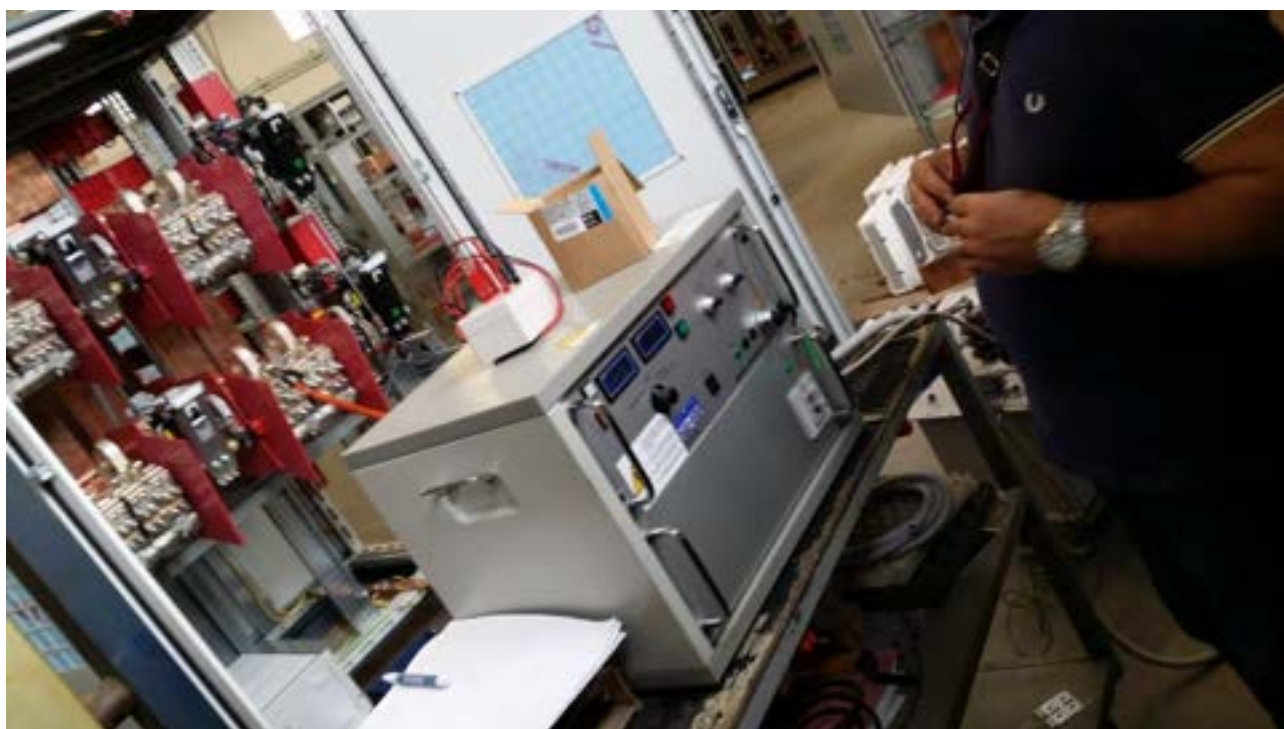
Figura 12. Un momento del test di isolamento sull'armadio finale del BPS. È visibile il generatore di test a 20 kV per 60 s con controllo della corrente di dispersione.
