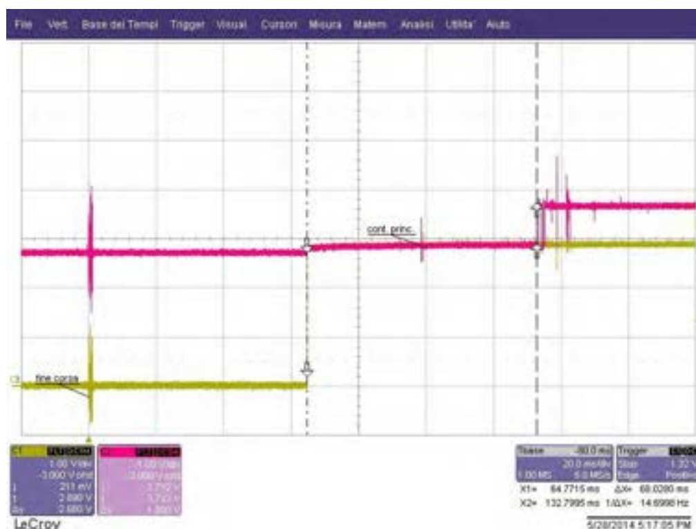
Figura 17. Schermata dell'oscilloscopio per la misura del tempo di chiusura meccanica del BPS. In questo caso, il tempo di chiusura stimato è intorno al valore medio tra le ripetizioni (circa 68 ms).
