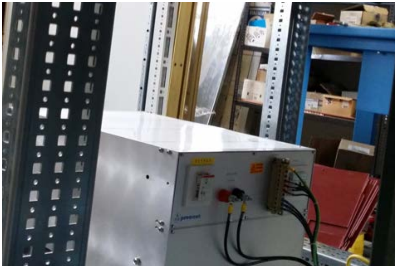
Figura 13. Il nuovo alimentatore ausiliario del BPS installato dopo i test preliminari.
