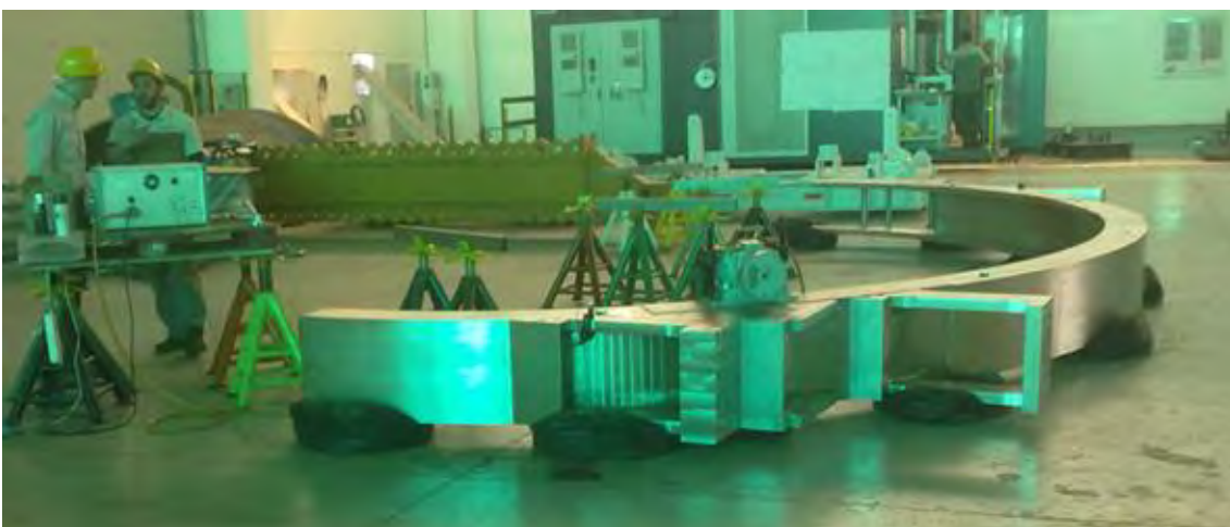
Figura 5: Vibration stress relief (VSR) sulla gamba curva.
