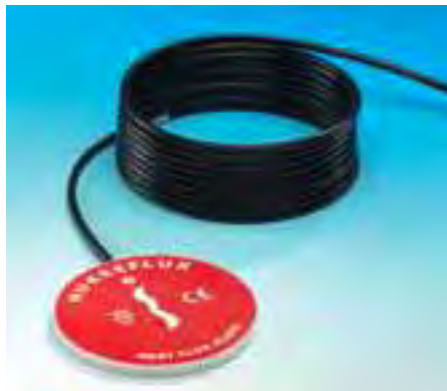
Figura 37 immagine del termoflussimetro
