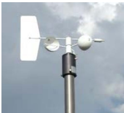
Figura 35 disegno e immagine dell'anemometro
