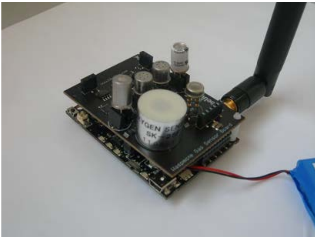
Figura 6: Nodo sensoriale Libelium con scheda madre, scheda sensori, batteria ed antenna per trasmissione e ricezione dati.
