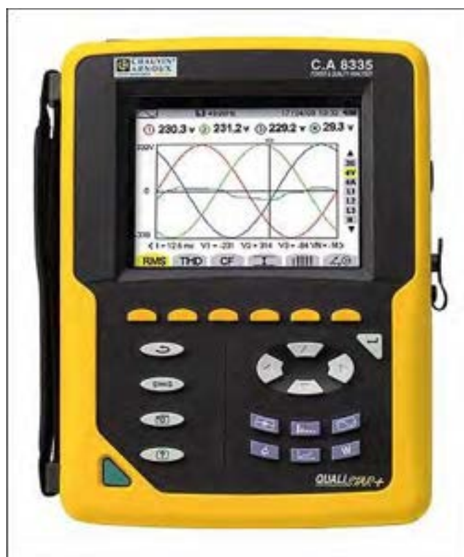
Figura 7. Power and energy quality analyser utilizzato nelle misurazioni in ambito residenziale
