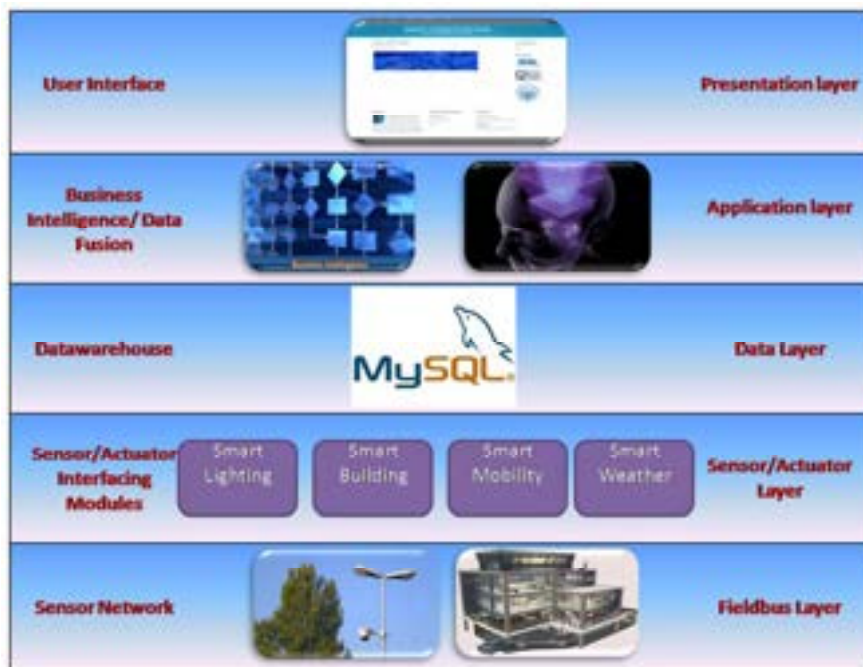
Figura 1. Struttura logica della Piattaforma SCADA
