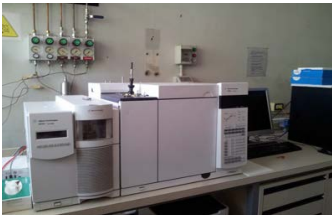
Figura 2.5.3: Spettrometro di massa accoppiato al Gascromatografo.
