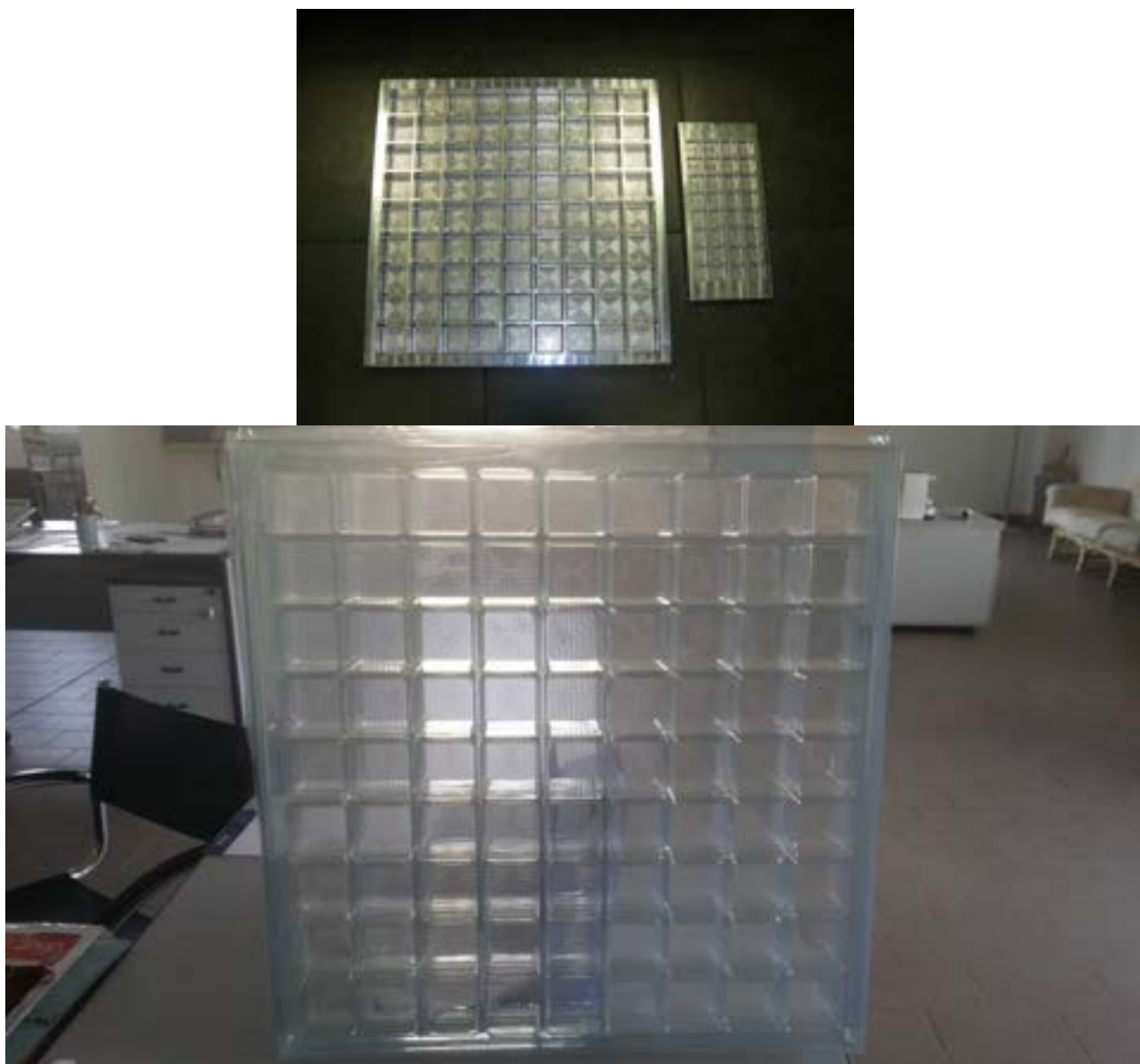
Figura 2.1.2: Prototipi definitivi di contenitore della paraffina
