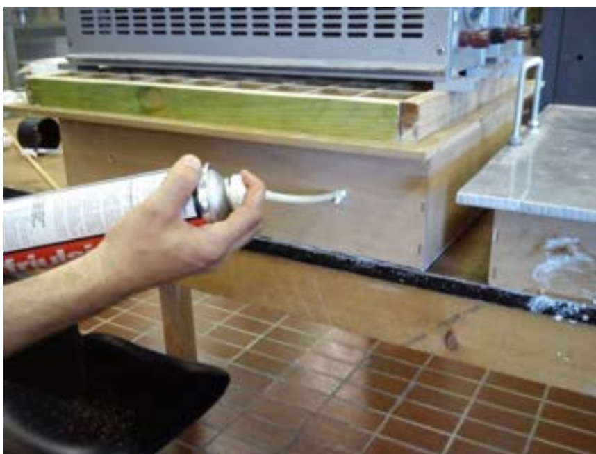
Figura 2.2.12: Espansione ed essiccazione schiuma poliuretanica.
