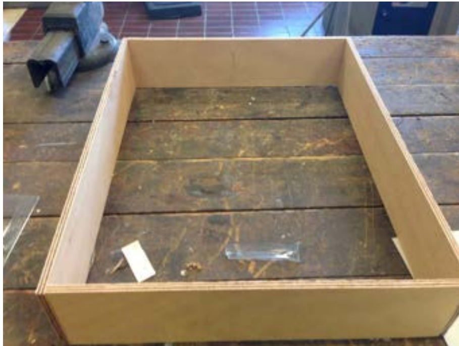
Figura 2.2.3: Telaio in legno per realizzazione pannello multistrato.
