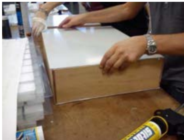
Figura 2.2.8: Chiusura del pannello multistrato.
