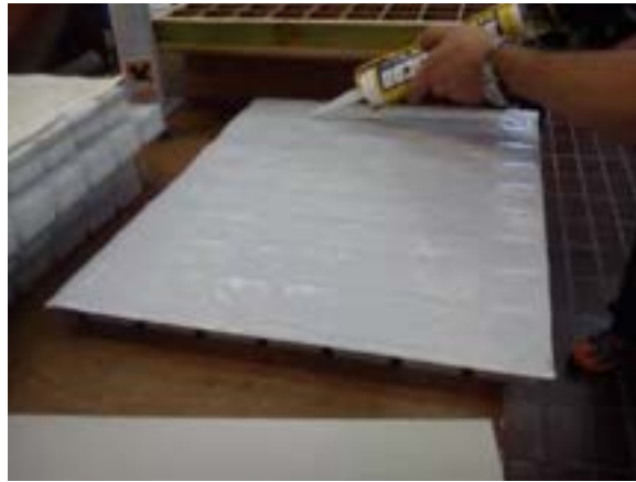
Figura 2.2.6: Sigillante applicato al sistema di contenimento del PCM.
