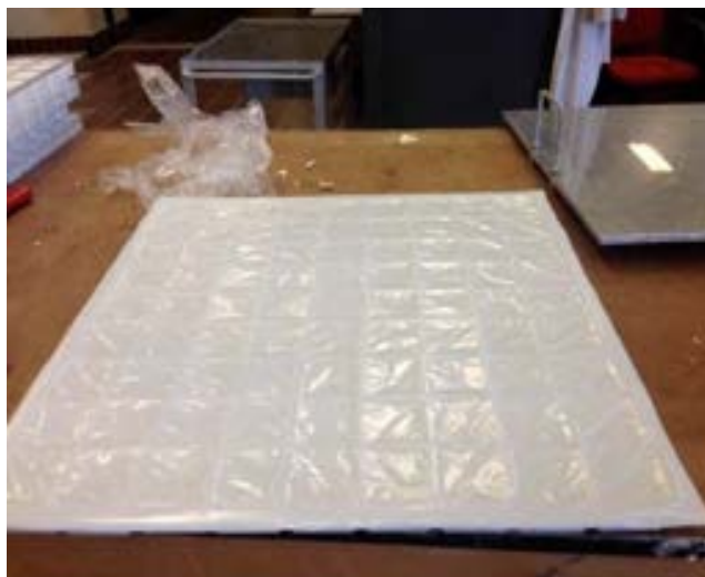
Figura 2.1.5: Struttura di contenimento del PCM pronta per l'uso.
