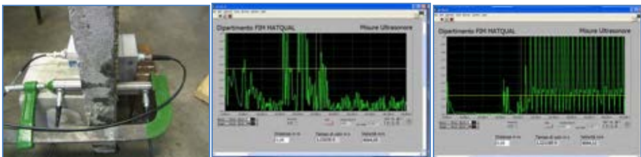
Figura 2.6.2: Confronto tra sonde convenzionali e sonde non a contatto. Presentazione ASCAN: al centro è visualizzato il segnale relativo alle sonde non a contatto; a dx il segnale relativo a sonde convenzionali a contatto.
