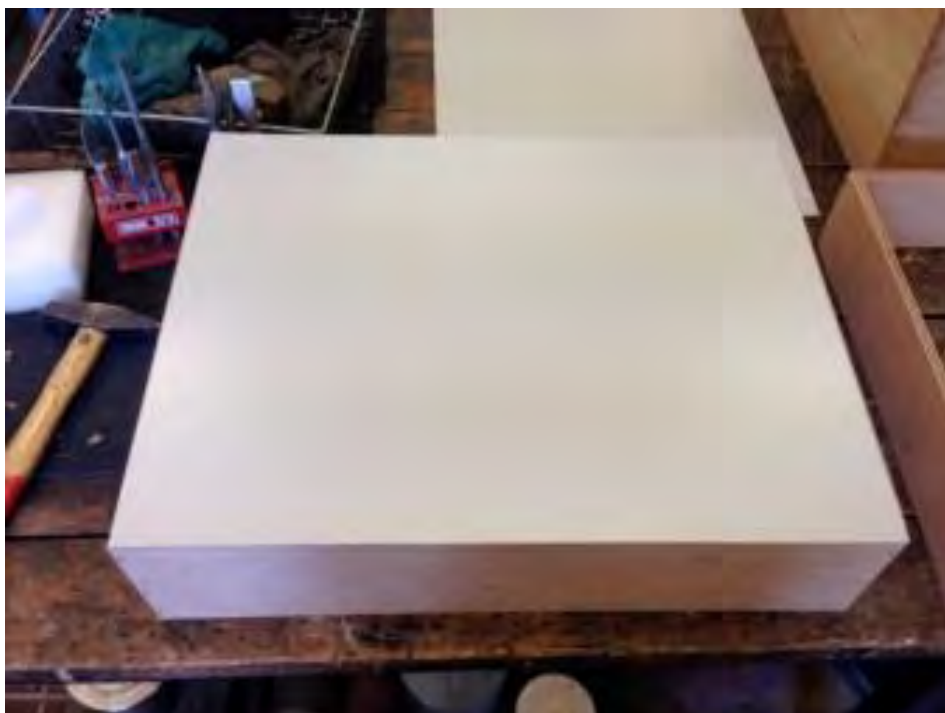
Figura 2.2.5: Pannello chiuso con lamierini in acciaio preverniciato.
