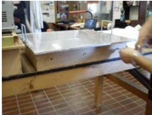
Figura 2.2.9: Realizzazione fori nel telaio.
