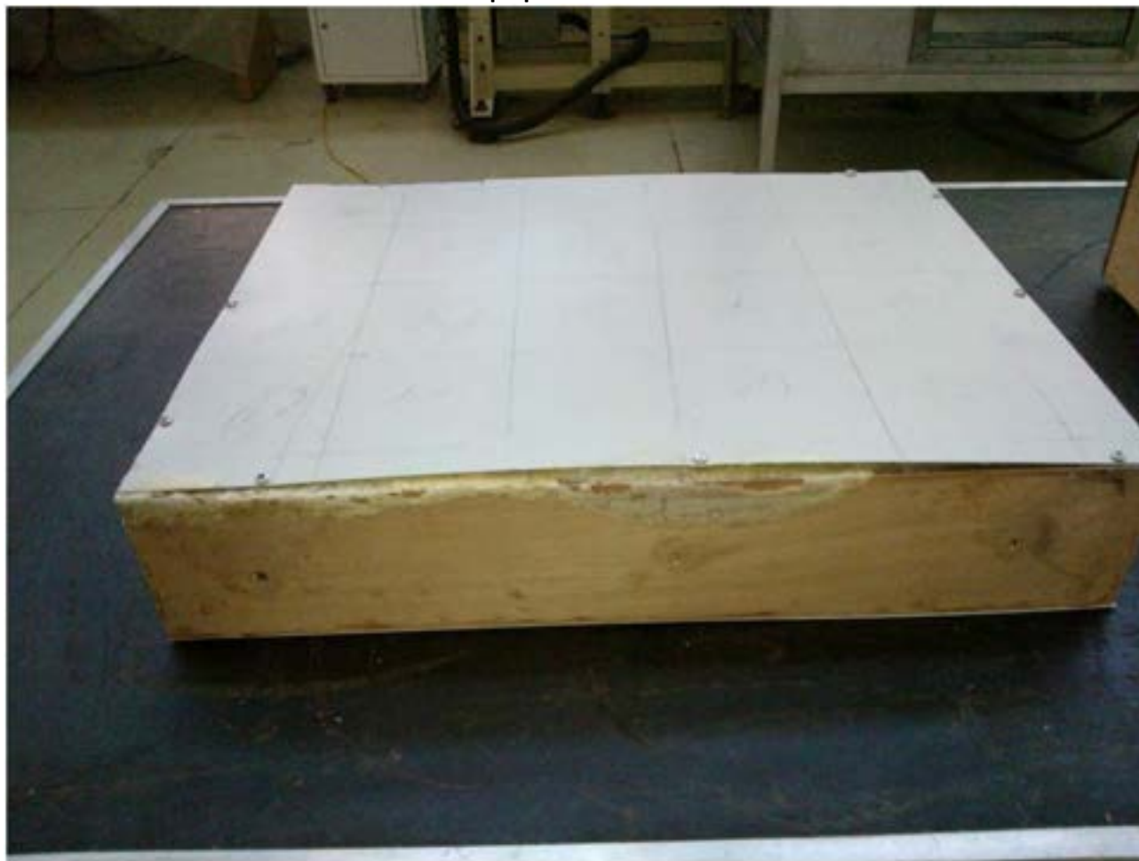
Figura 2.7.25: Pannello senza PCM Dimensioni 54 x 42 x 10 cm
