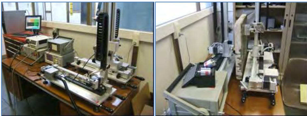
Figura. 2.6.1: Sistema automatico con sonde non a contatto
