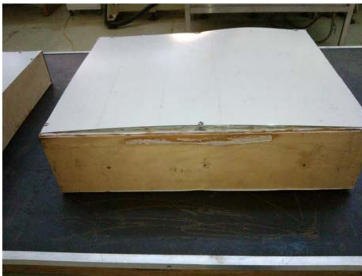
Figura 2.7.27: Pannello con PCM Dimensioni 54 x 42 x 14 cm
