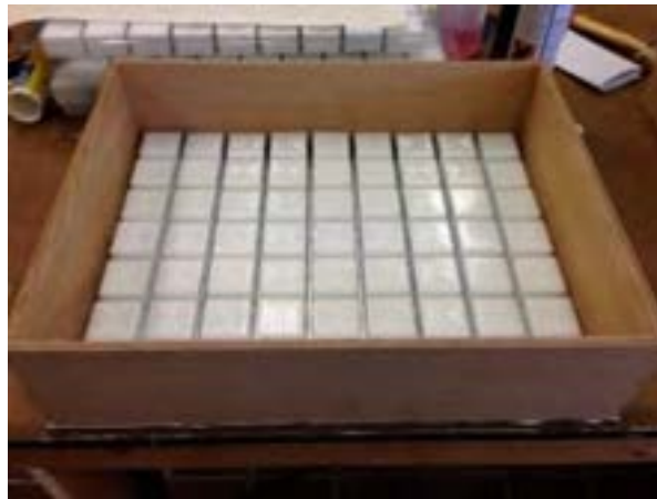
Figura 2.2.7: Posizionamento struttura di contenimento del PCM all'interno del pannello
