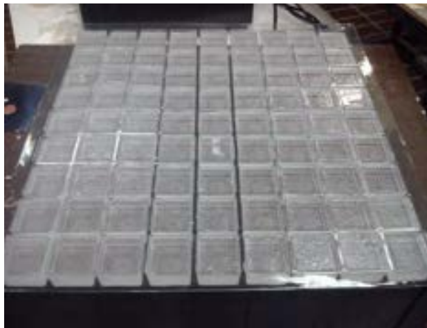
Figura 2.1.3: Struttura di contenimento con PCM ancora in fase liquida.
