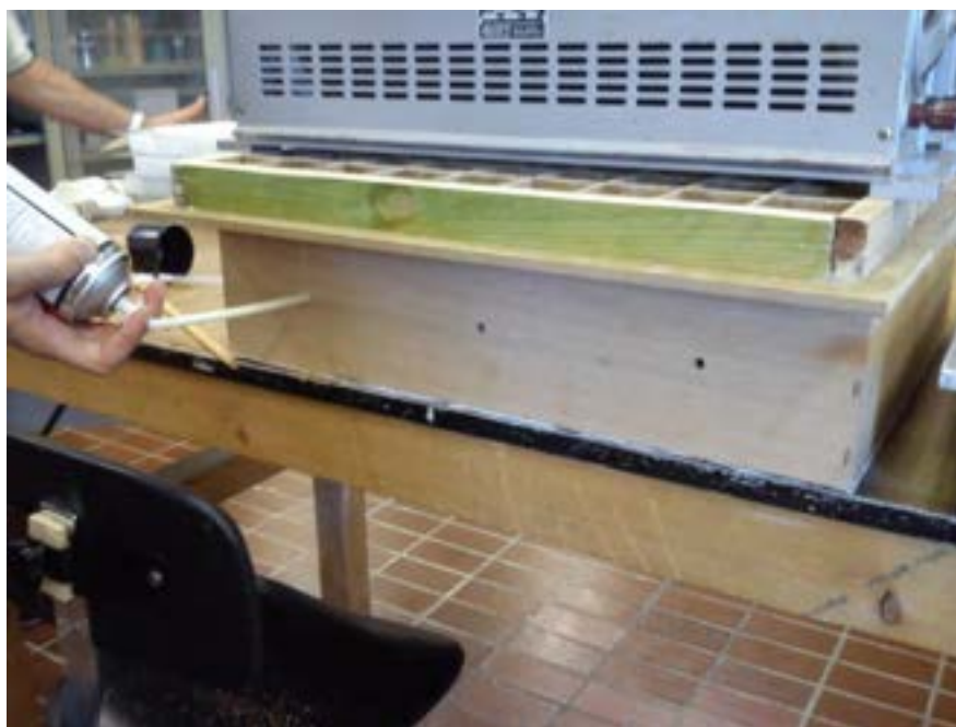
Figura 2.2.11: Schiumatura in poliuretano.
