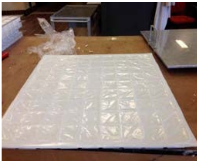
Figura 46. Il pannello sigillato contenente il PCM
