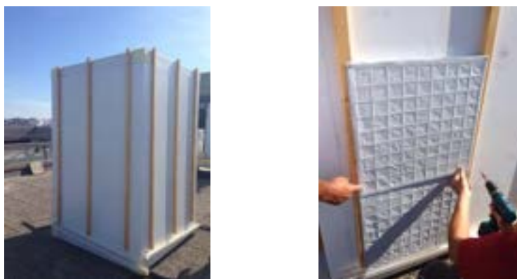
Figura 66. Prime fasi del montaggio dei contenitori di PCM
