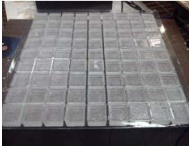
Figura 43. Riempimento del modulo contenitore con PCM in fase liquida
