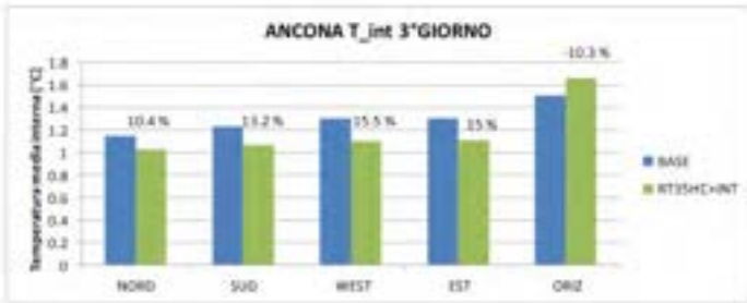
Figura 20. Confronto delle temperature medie superficiali interne a treno fermo.
