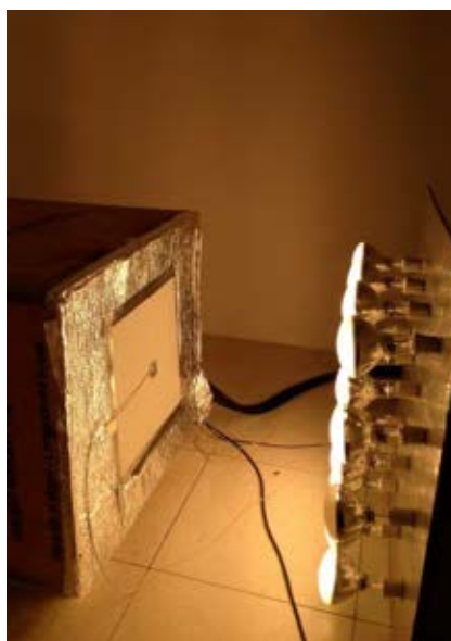
Figura 59. Immagine ripresa durante una prova indoor con il simulatore solare
