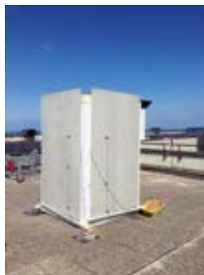
Figura 68. Completamento dell'allestimento della celle frigo di prova.
