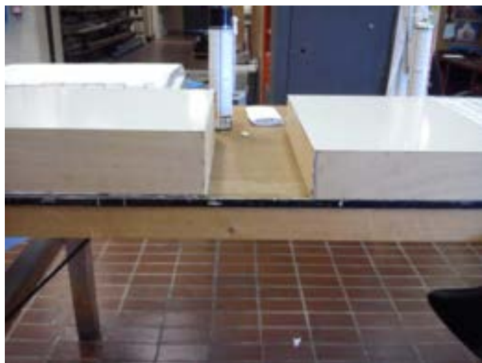
Figura 50. I pannelli prototipo: da sinistra quello con PCM e quello base
