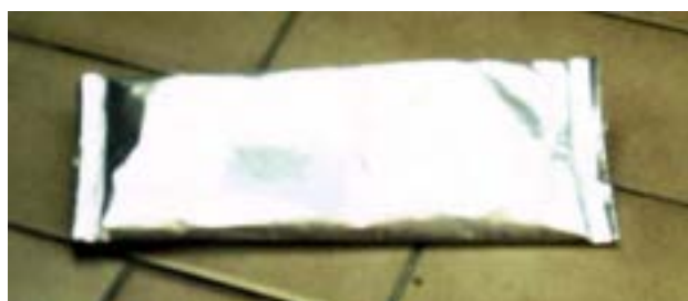
Figura 35. A destra la busta riempita con il PCM, a destra la deformazione della busta dopo cicli di passaggio di fase.
