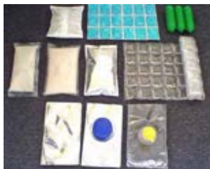
Figura 34 Modalità di packaging con buste in foglio laminato polimero alluminio .
