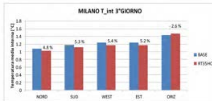
Figura 23. Confronto delle temperature medie superficiali interne a treno fermo.
