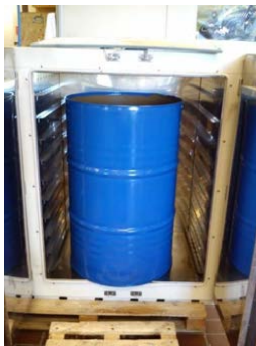
Figura 42. Riscaldamento in forno per liquefazione
