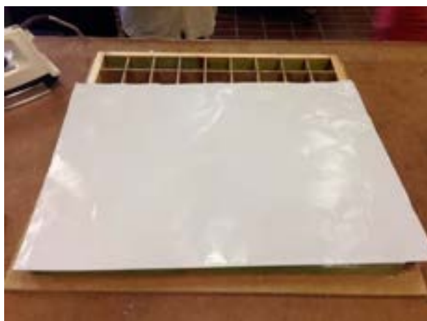
Figura 45. Fase di sigillatura del contenitore
