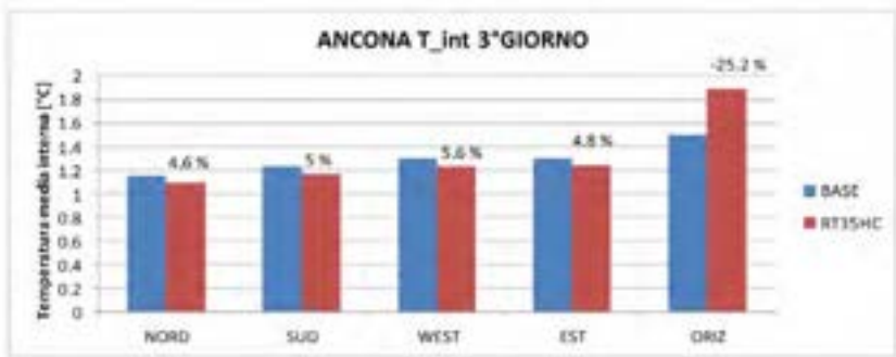
Figura 20. Confronto delle temperature medie superficiali interne a treno fermo.
