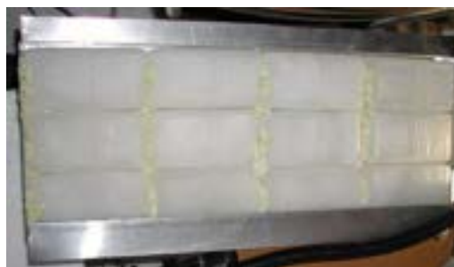
Figura 38. Contenitori di PCM in scatole di polimero
