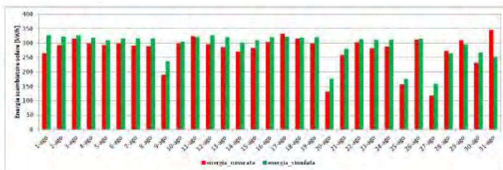
Figura 15 - Confronto tra l'energia dello scambiatore solare misurata e simulata nel mese di agosto.
