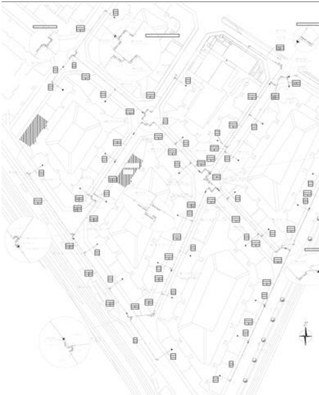
Figura 2 - Schema della rete di teleriscaldamento
