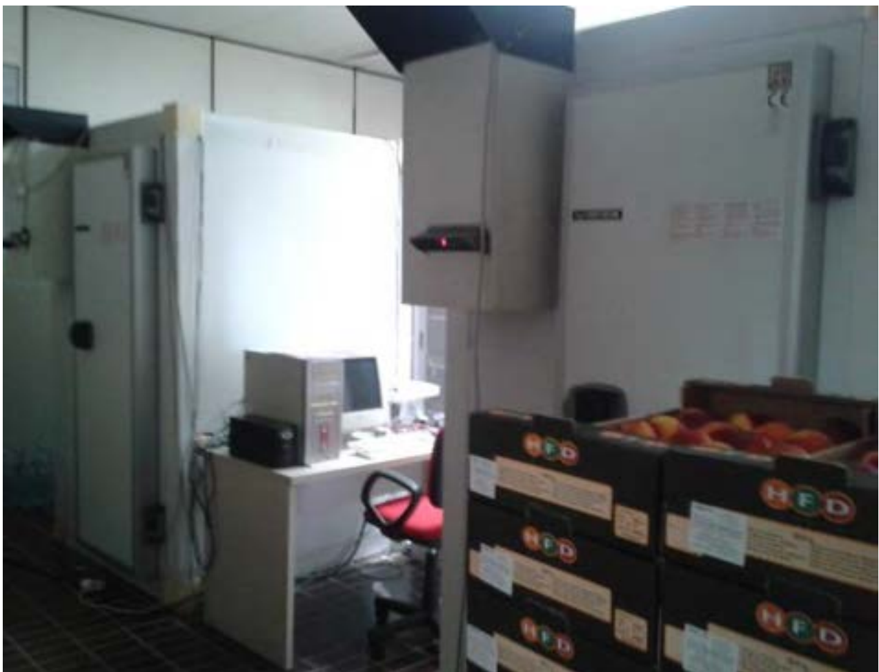
Figura 2.2.2.1: Laboratorio UNPM con cella di riferimento e cella dotata di PCM durante la campagna sperimentale con pesche noce.
