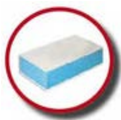
Figura 2.1.1: pannello sandwich tipico della Plastoblok. Esterno: Laminato in fibra di vetro, rinforzato con resina poliesteri (con oltre il 35% di Fibra di vetro e Gelacoat ca. RAL9010 a finire. Isolante : Poliuretano e/o Polistirene, rigido in lastre calibrate, a basso assorbimento d'acqua.
