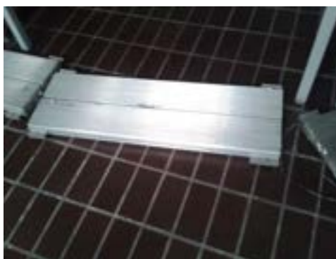
Figura 2.2.3: Fotografia di uno dei tre moduli con i due contenitori di PCM.
