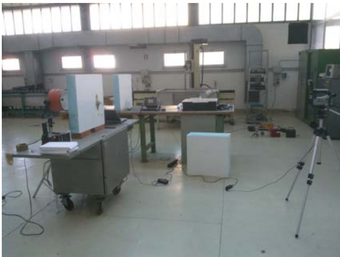
Figura 2.1.2.14: Setup sperimentale per l'esame termografico dei pannelli
