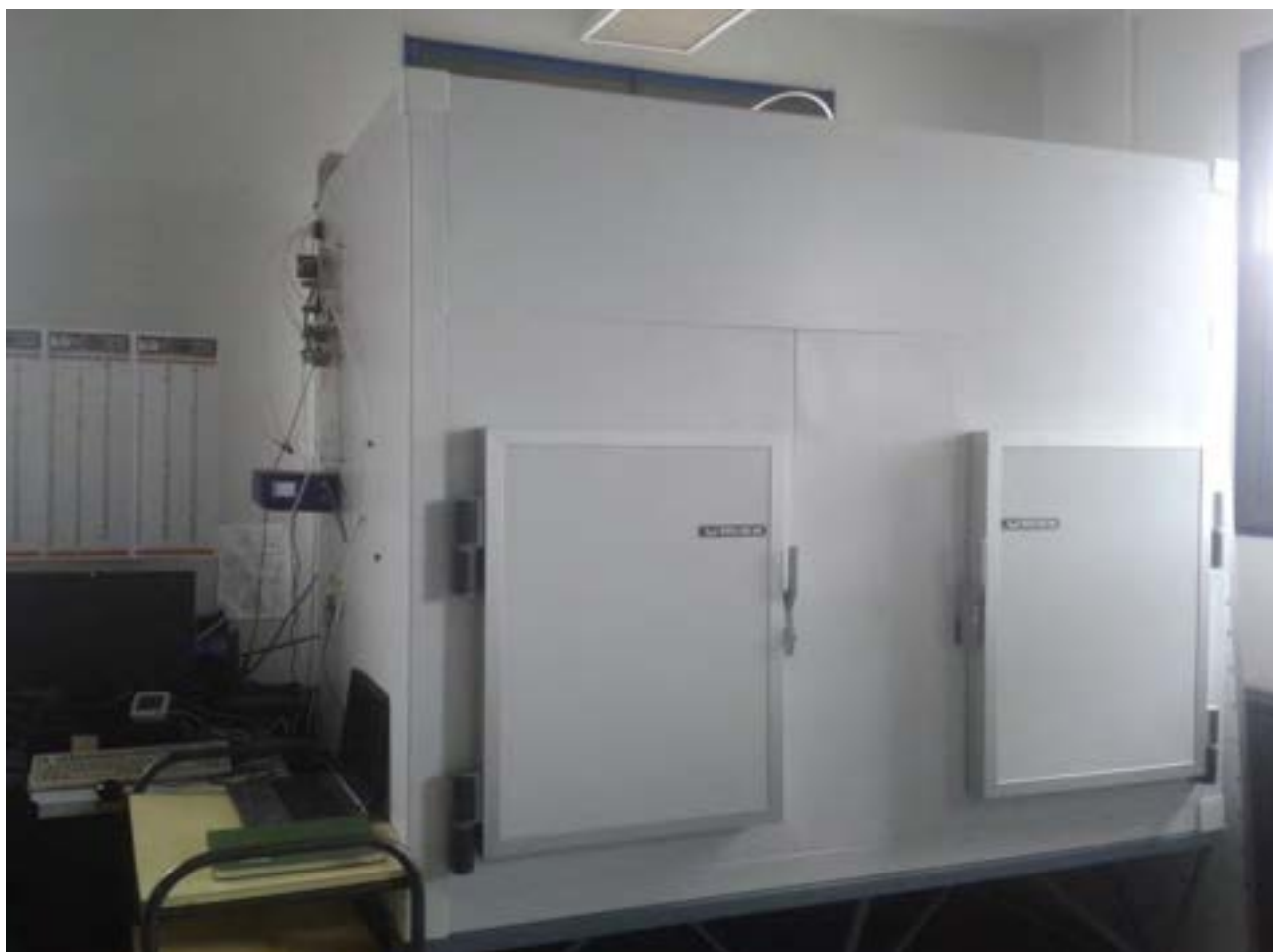
Figura 2.2.1.1: cella Misa laboratorio Casaccia allestita per il monitoraggio automatico dello spazio di testa dei prodotti ortofrutticoli stoccati. L'involucro ha lo spessore di 6cm, ha due porte e le dimensioni sono diverse dalle celle presso UNIPM per simulare i volumi dei reefer in scala.
