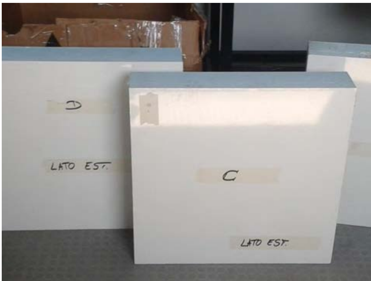
Figura 2.1.1.2: Vista complessiva dei prototipi C e D dei pannelli finiti, si nota sul prototipi C, realizzato con i canali identici al prototipo B, il foro utilizzato per riempire col PCM i canali dopo l'incollatura. Sono evidenziati i lati esterni dei pannelli a cui è adiacente (C) o a contatto (D) il PCM.
