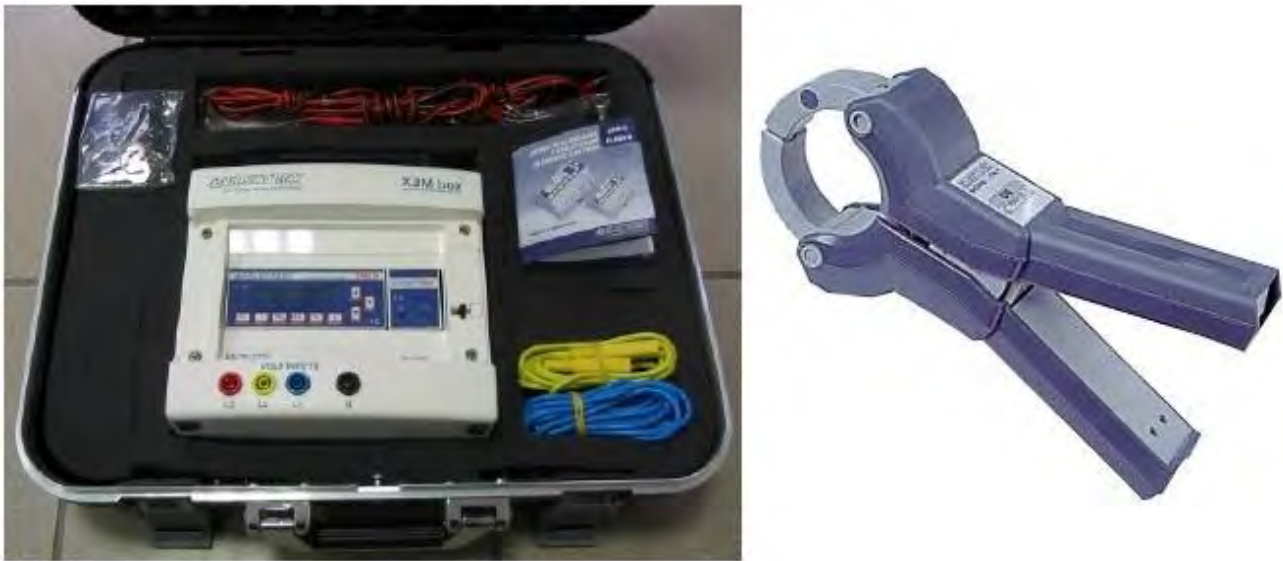
Figura 8: strumento di misura e pinza amperometrica
