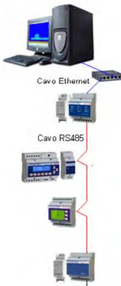
Figura 38: schema tipico di sistema di monitoraggio energetico via WEB
