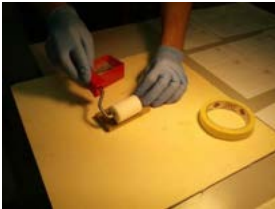
Fig. 44 - Depositione della resina tramite rullo per vernici acriliche
