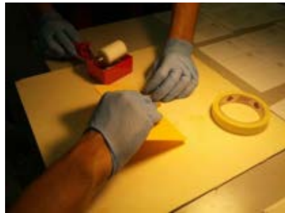
Fig. 45 - Rimozione della resina eccedente tramite spatolatura
