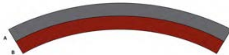
Fig. 56 – Strisce connesse di materiali diversi sottoposti a stimolo termico
