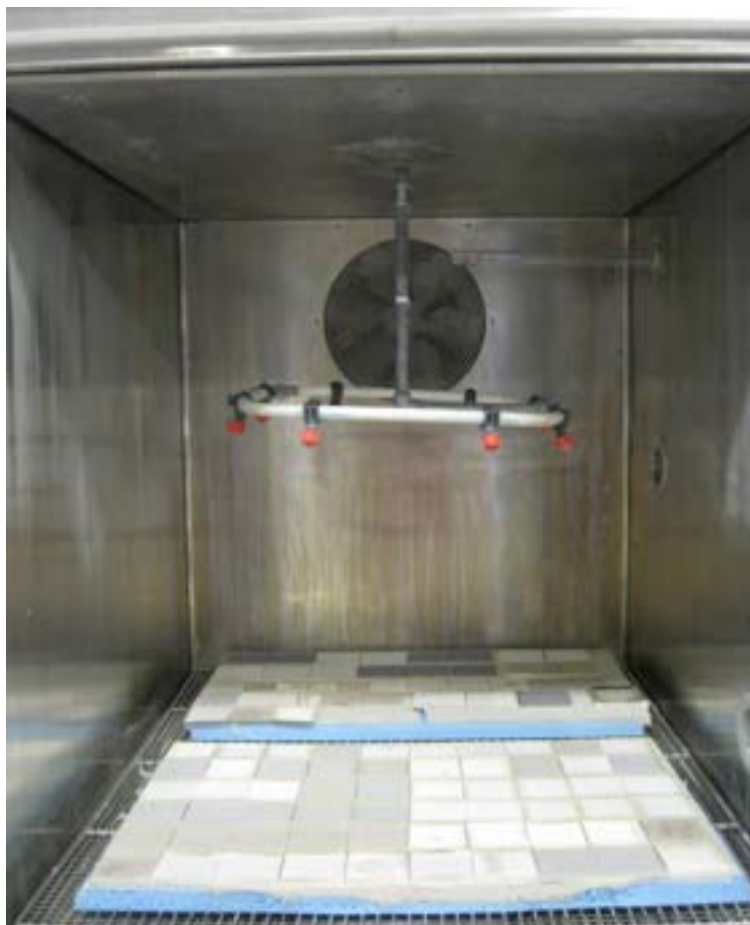
Figura 17. Cella climatica utilizzata al Politecnico di Milano e campioni posizionati all'interno (si tratta degli stessi prodotti esposti naturalmente).
