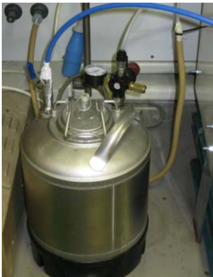
Figura 15. Serbatoio utilizzato al Politecnico di Milano per la nebulizzazione.
