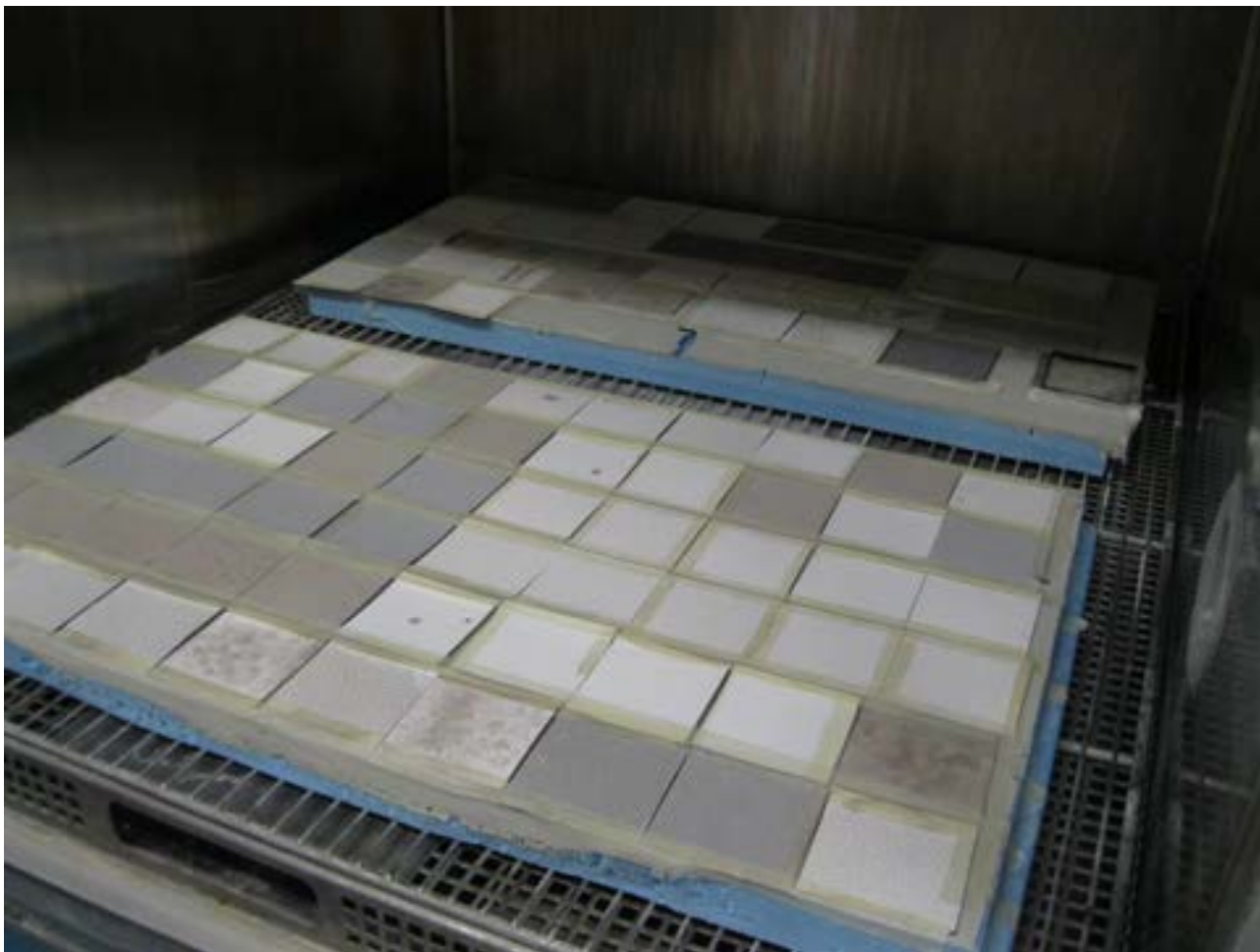
Figura 18. Dettaglio dei campioni posizionati all'interno della camera climatica.
