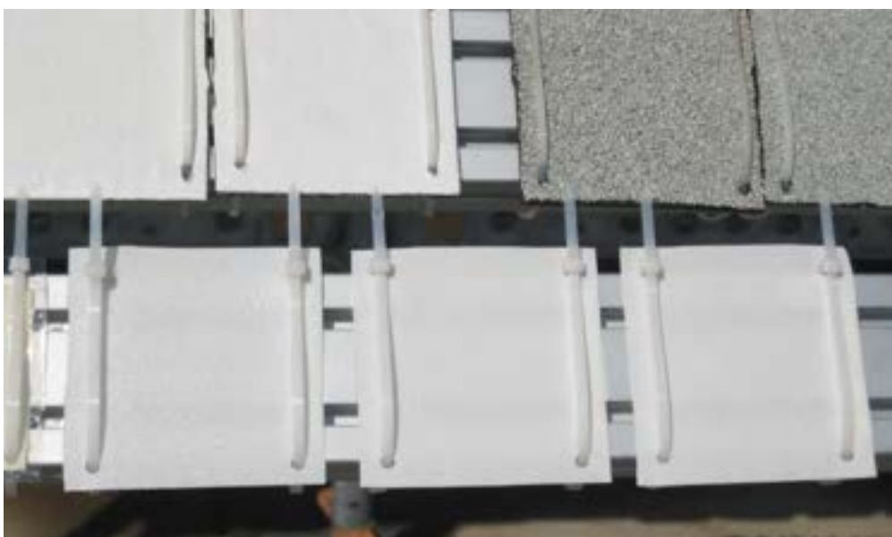
Figura 4. Dettaglio del fissaggio al supporto d'esposizione.
