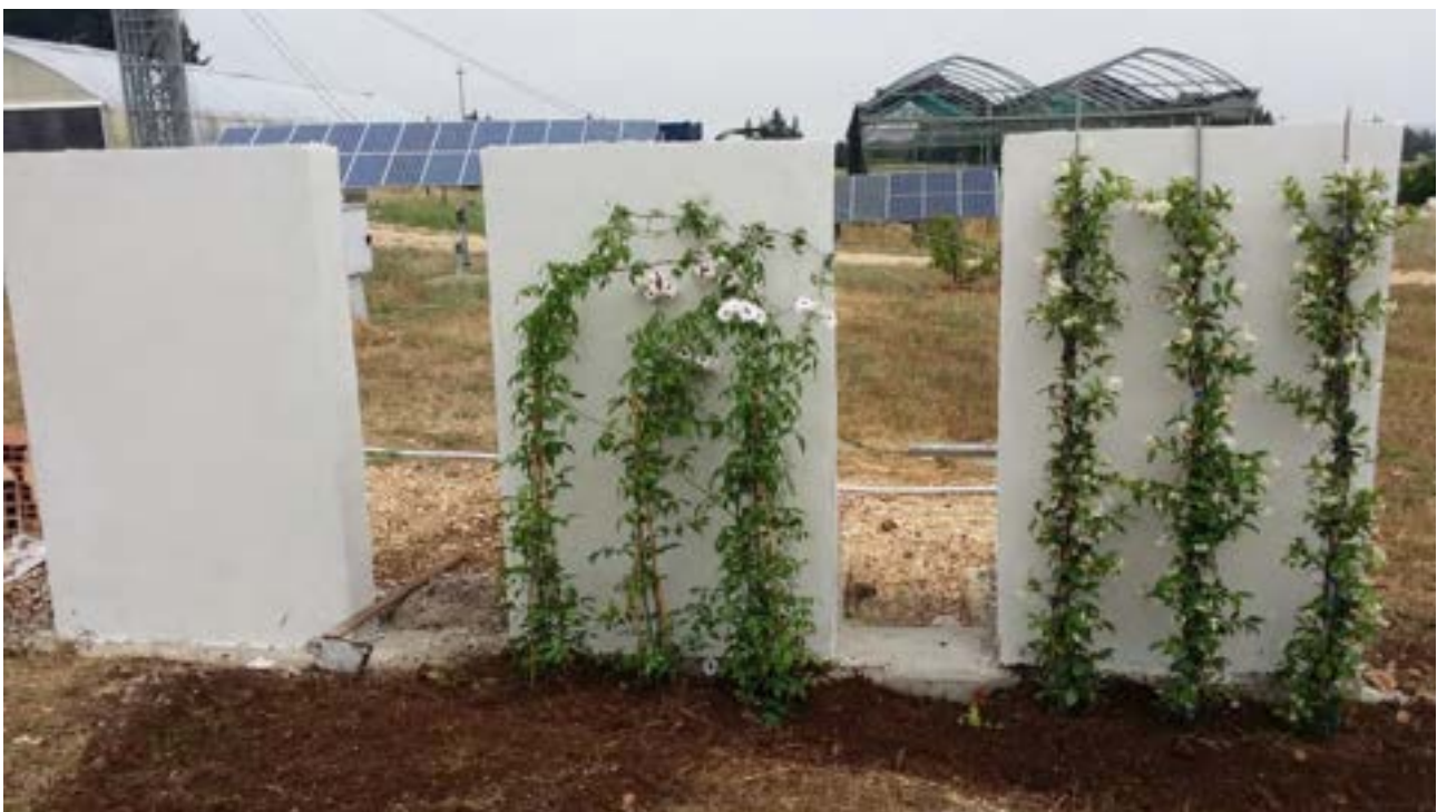
Figura 2.2.3: Le tre pareti presso il campo sperimentale dell'Università di Bari; la parete a destra è ricoperta da Rhynchospermum jasminoides , la parete centrale da Pandorea jasminoides variegata mentre la parete nuda a sinistra è il testimone (18 Giugno 2014).
