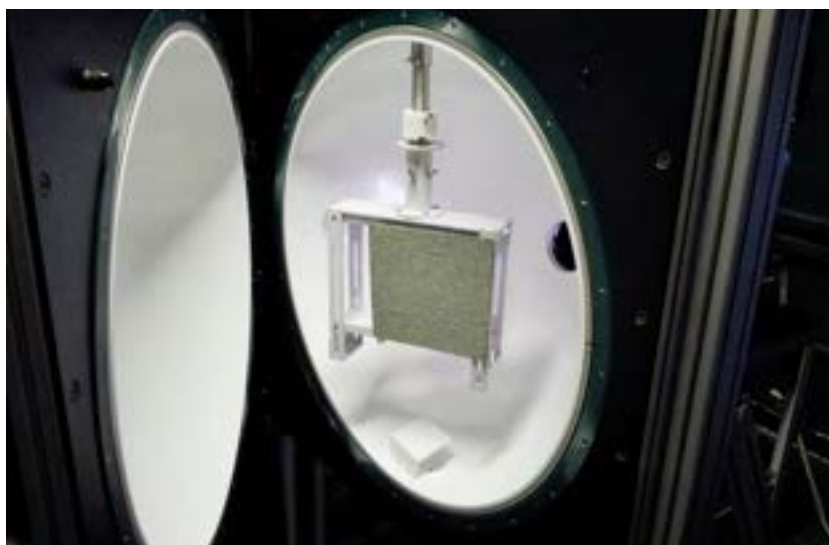
Figura 13. Campione posizionato al centro della sfera sul braccio rotante
