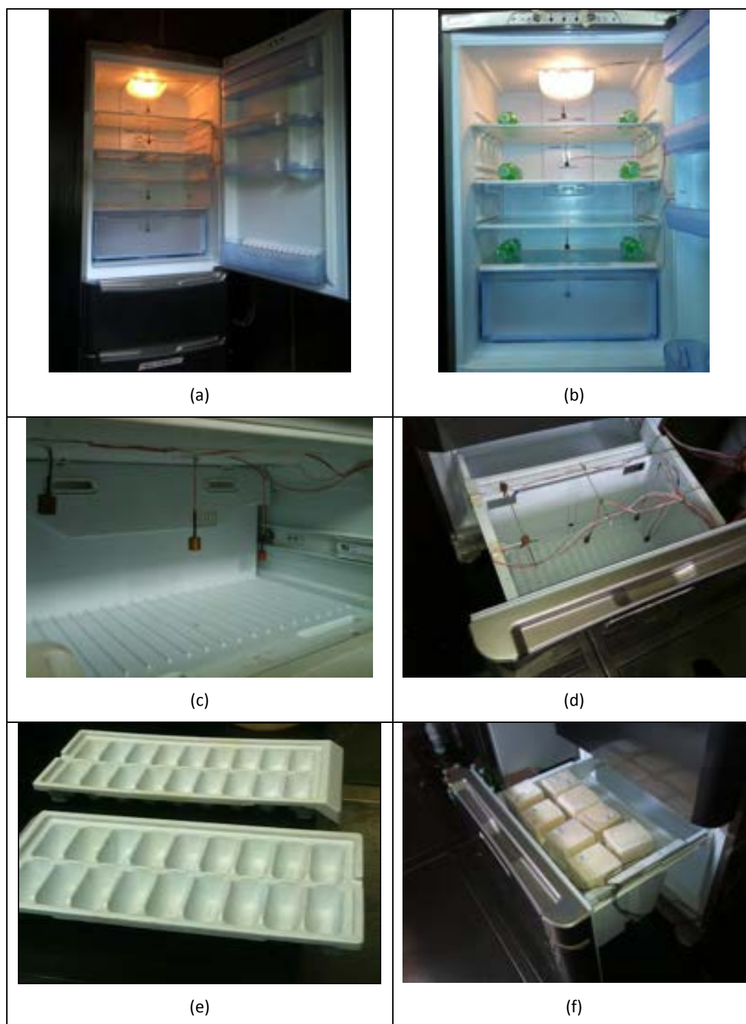
Figura 8. Foto relative ai test condotti: a) setup del vano cibi-freschi; b) prova di Load nel vano cibi freschi; c) strumentazione del vano FTZ; d) strumentazione dello scomparto freezer; e) vaschette per ghiaccio utilizzate nei vani a bassa temperatura durante le prove di Load ; f) carico dello scomparto freezer durante le prove di Storage .
