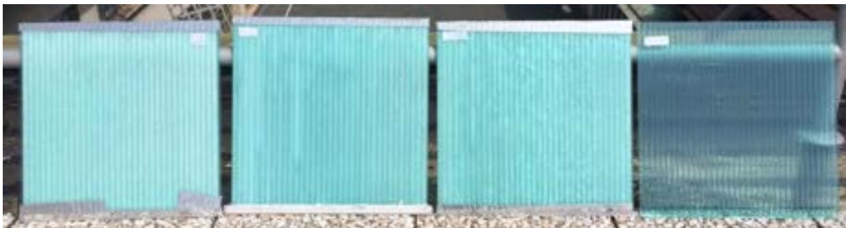
Figura 15 Configurazione 2 variante PCM pannelli verdi. Da sinistra pannello Verde_B_PCM_35, Verde_P_PCM_35, Verde_SH_PCM_31 e pannello vuoto verde.
