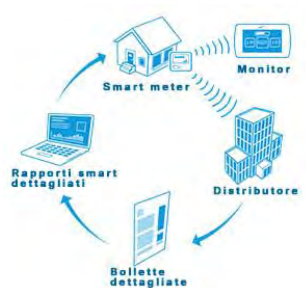
Figura 7. Schema del funzionamento dello smart metering
