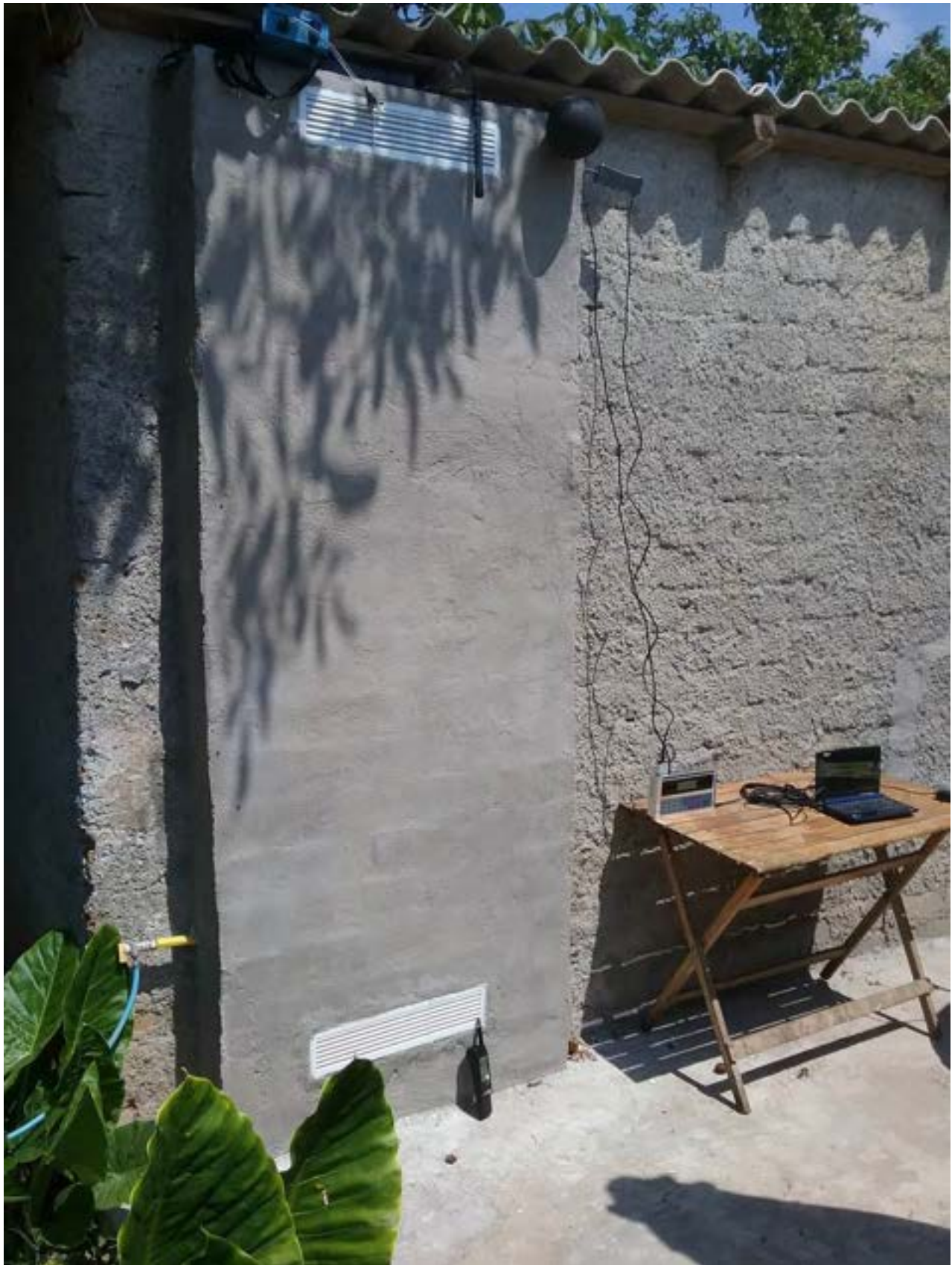
Figura 6. Sezione di prova strumentata del modulo di parete di altezza 2,3 metri
