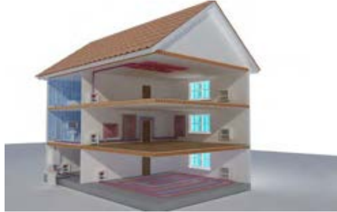
Figura 38. Sistemi di riscaldamento a pannelli radianti
