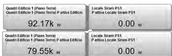
Figura 3: lettura del dato all'istante T0 e all'istante T1 con disattivazione dell'UTA
