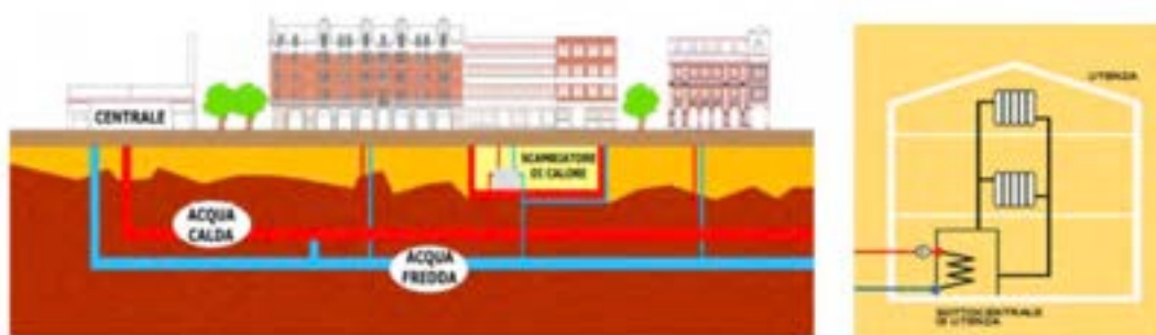
Schema 1: una rete di TLR e scambiatore in una utenza condominiale (fonte Indagine AGCM 2013)
