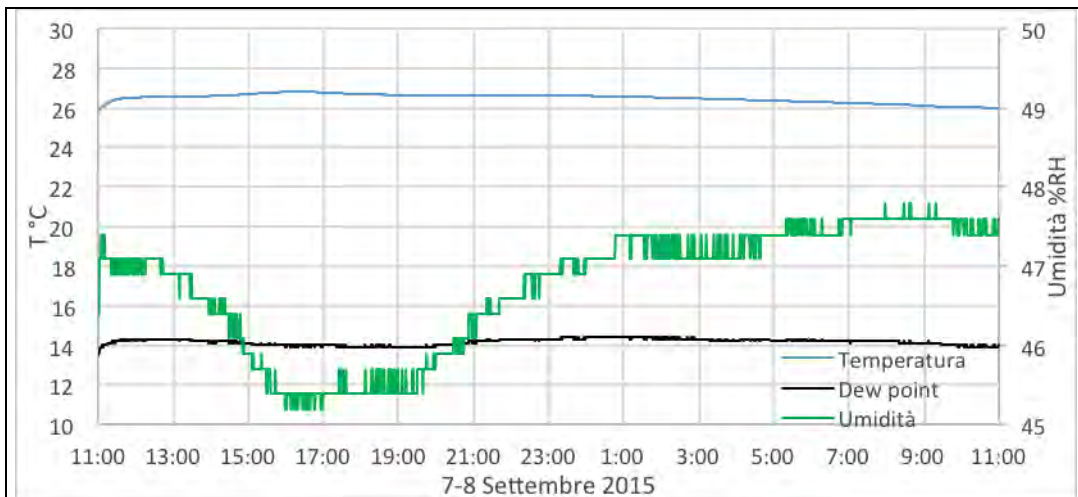
Figura 4-c Andamento di Temperatura, Umidità e Dew point misurati in posizione 2
