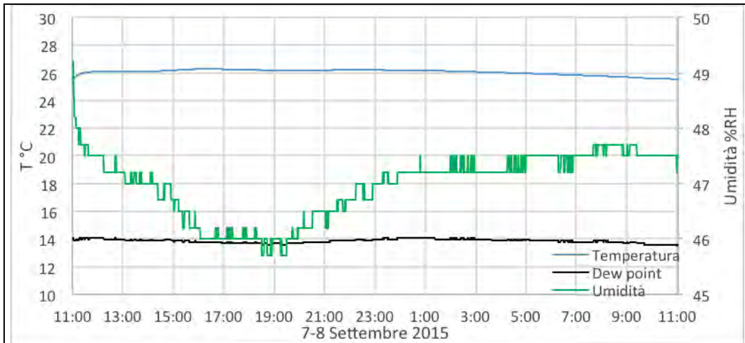
Figura 3-c Andamento di Temperatura, Umidità e Dew point misurati in posizione 1
