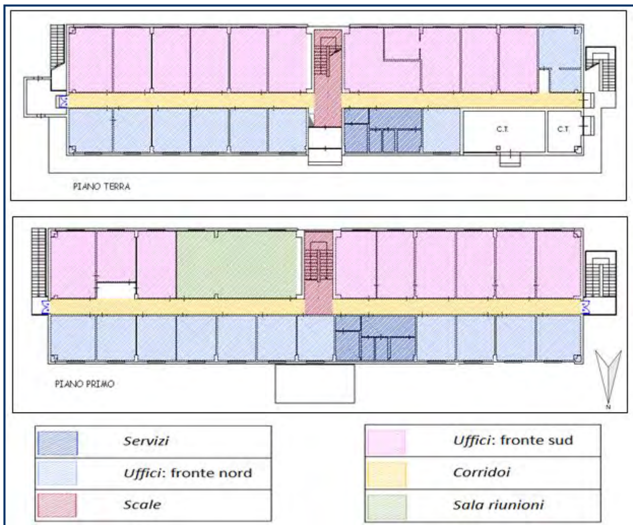
Figura 5: Distribuzione funzionale dei due piani costituenti l'edificio
