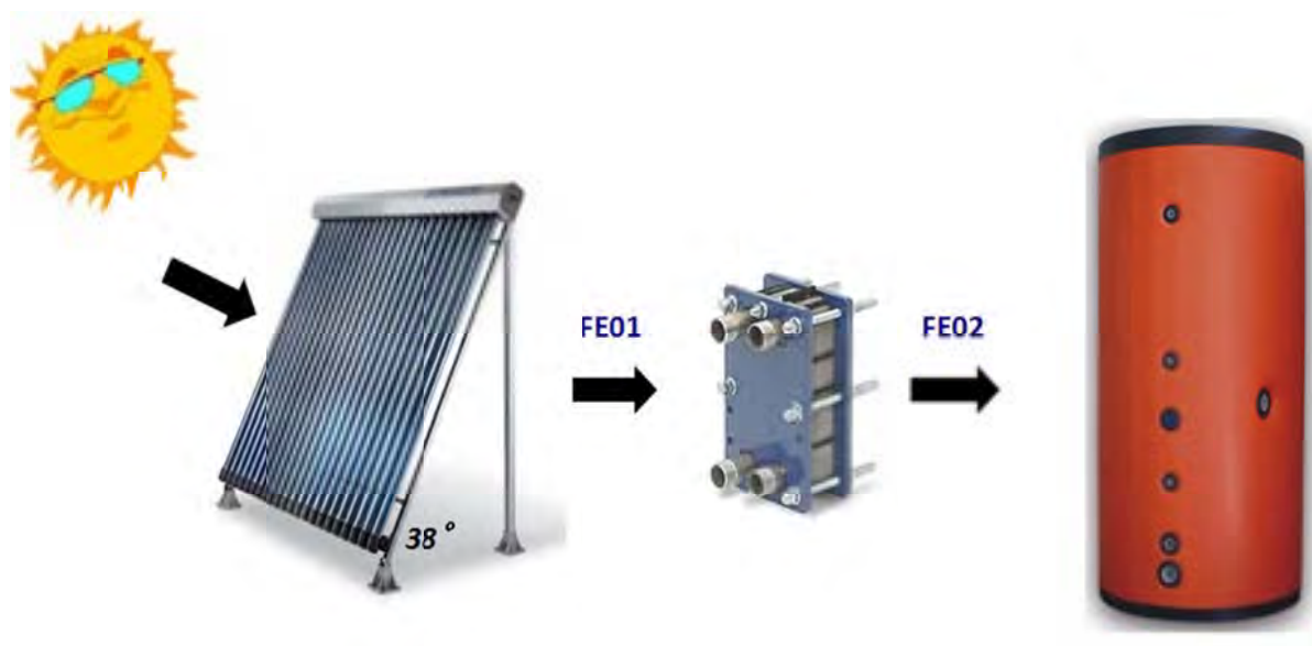
Figura 2. Schema produzione e fornitura energia a partire dai collettori solari
