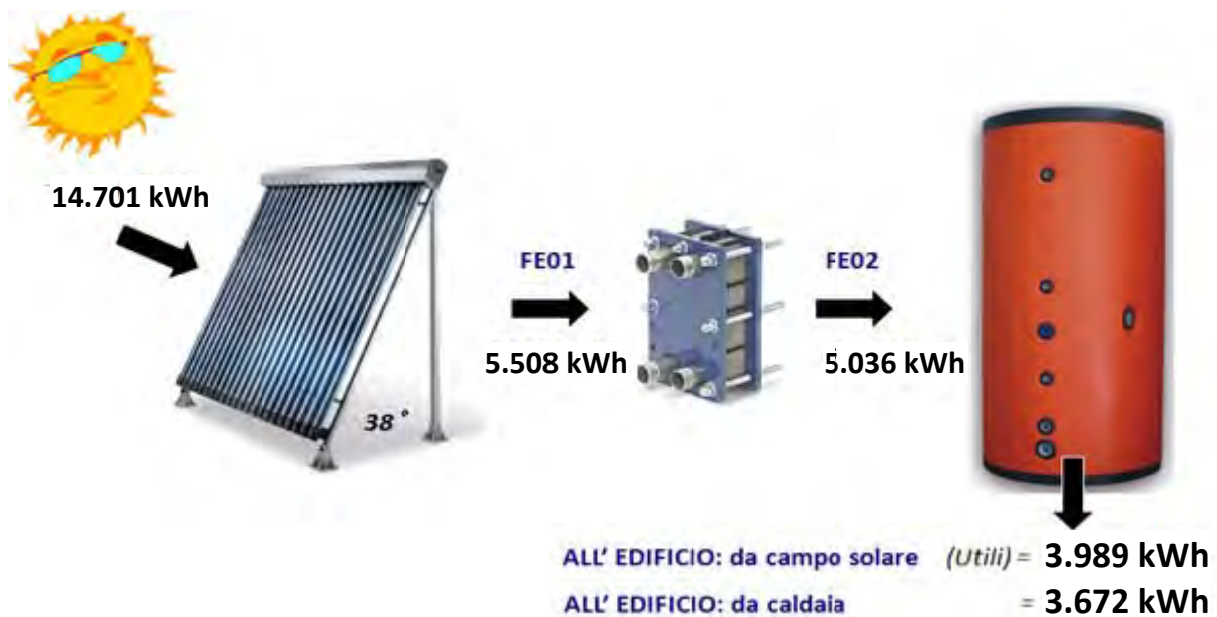
Figura 34. Schema produzione e fornitura energia a partire dai collettori solari durante il monitoraggio invernale 2013
