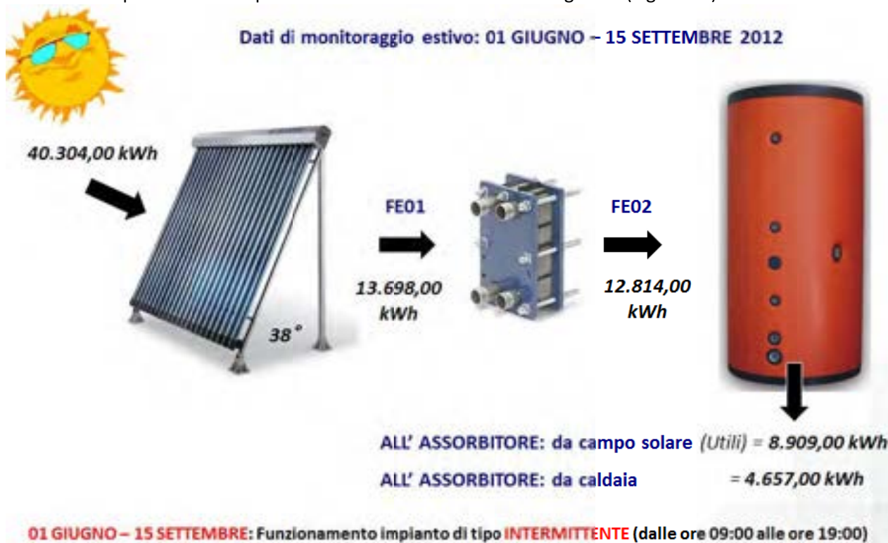
Figura 71. Schema produzione e fornitura energia a partire dai collettori solari (estate)
