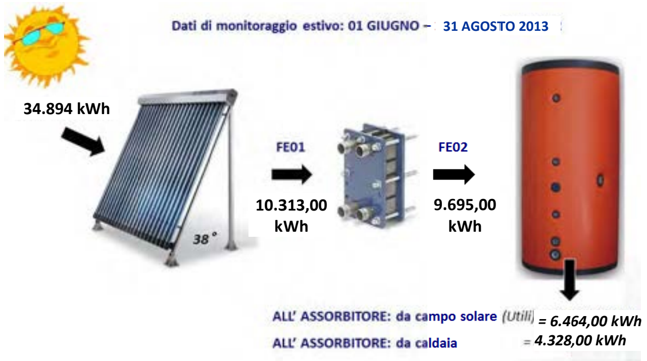
Figura 109. Schema produzione e fornitura energia a partire dai collettori solari (estate)
