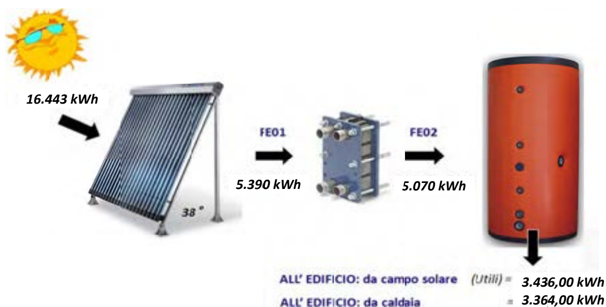
Figura 9. Schema produzione e fornitura energia a partire dai collettori solari durante il monitoraggio invernale 2012
