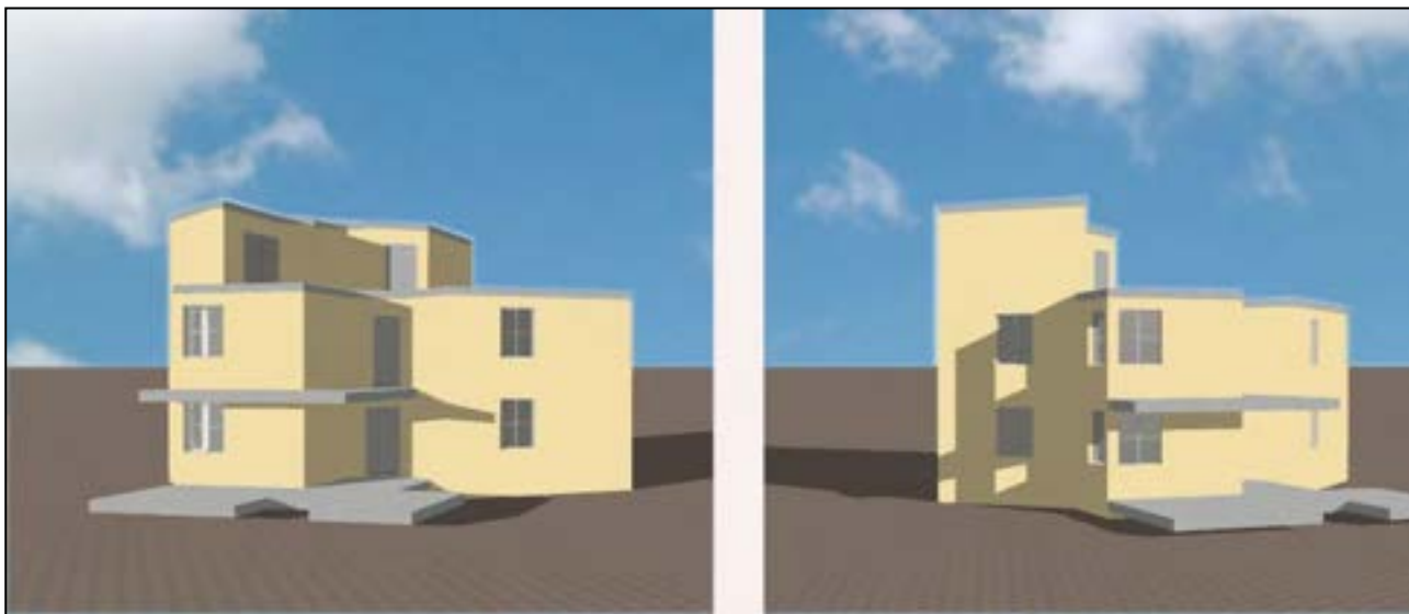
Figura 2.2.4 - Rendering del modello dell'edificio effettuato in DesignBuilder
