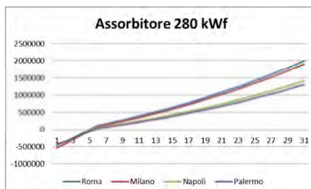
Figura 20: VAN attualizzato impianto da 280 kWf
