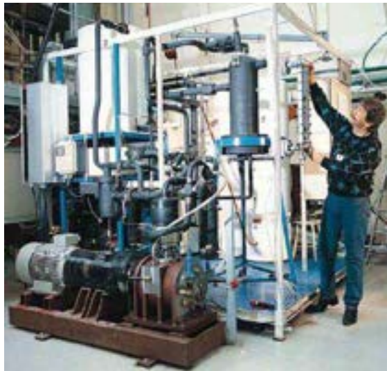
Figura 7 Prototipo di pompa di calore a CO 2 da 50 kW.
