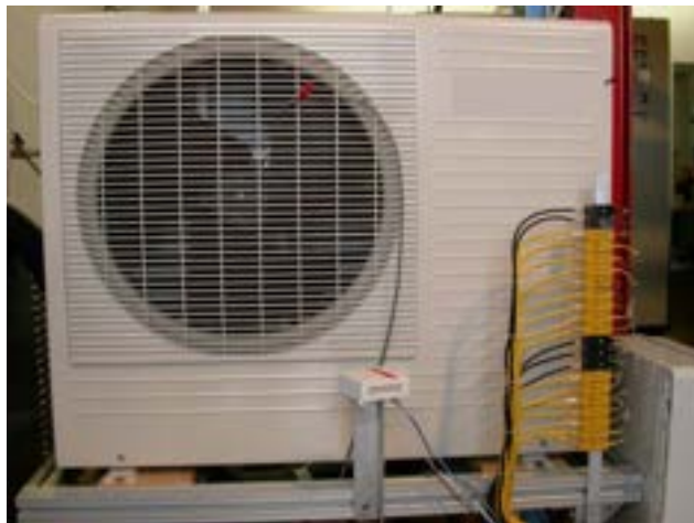
Figura 3 – Pompa di calore commerciale a CO 2 .
