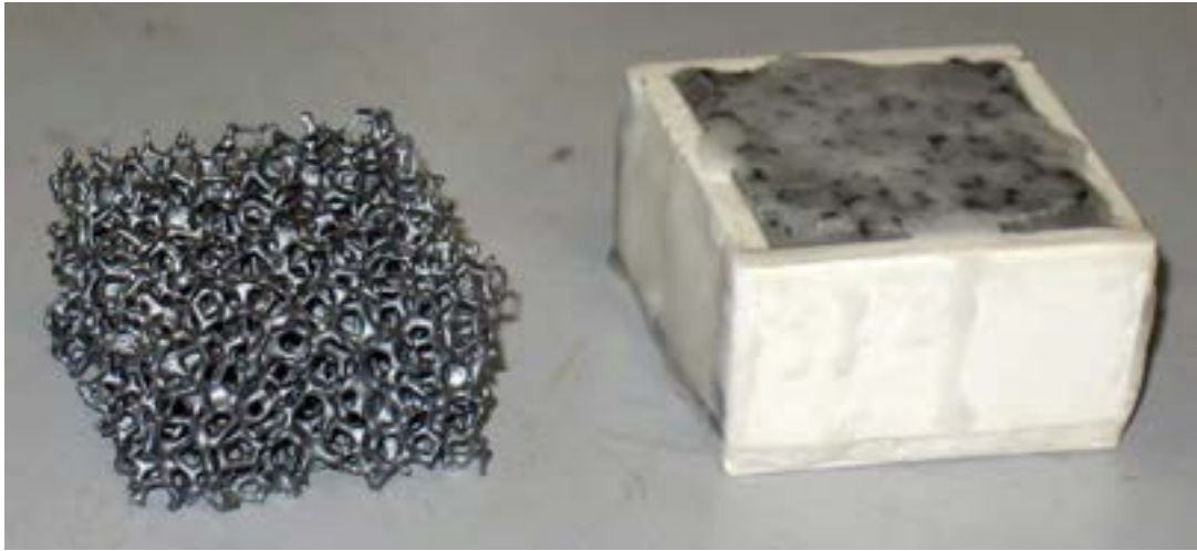
Figura 39 – blocchetto di schiuma di SiC e provino di schiuma riempita con la paraffina A46, in fase di preparazione per il test sperimentale
