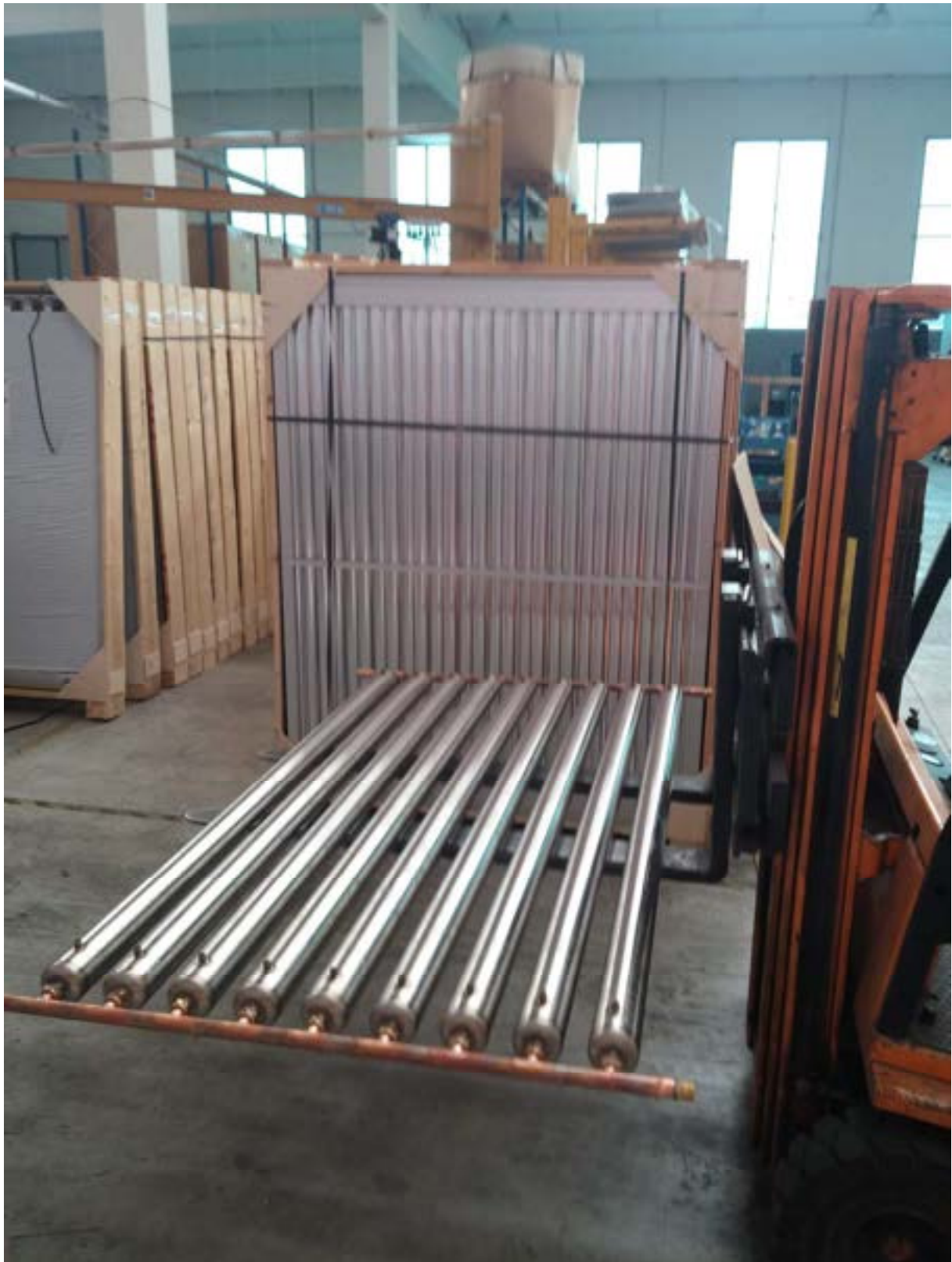
Fig. 23 – Disposizione dei tubi ricevitori e serbatoi.
