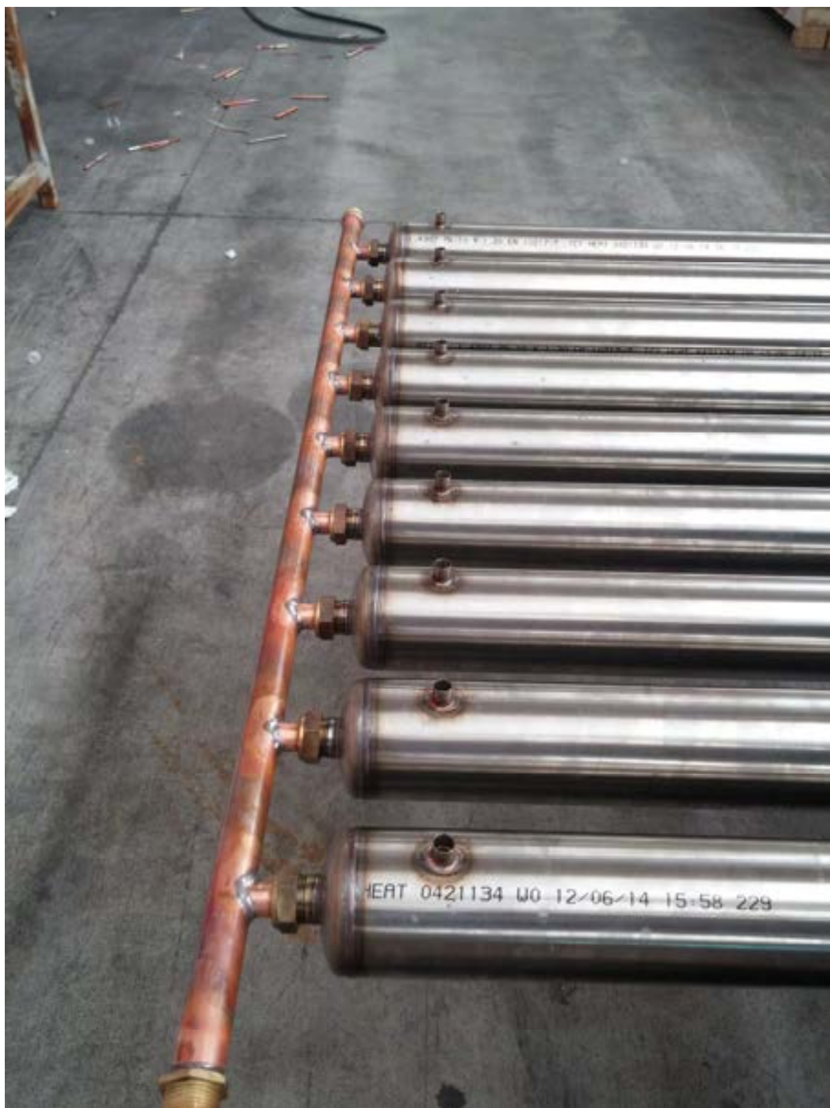
Fig. 24 – Particolare dell'attacco alla rete idrica.
