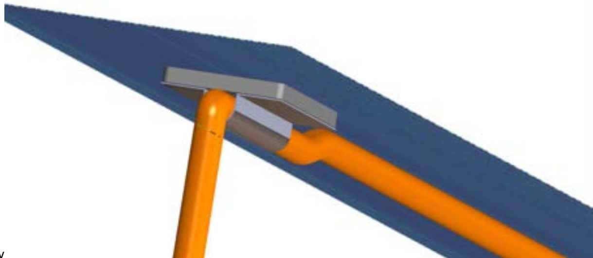
Fig. 17 – Spaccato della disposizione della vapor chamber .
