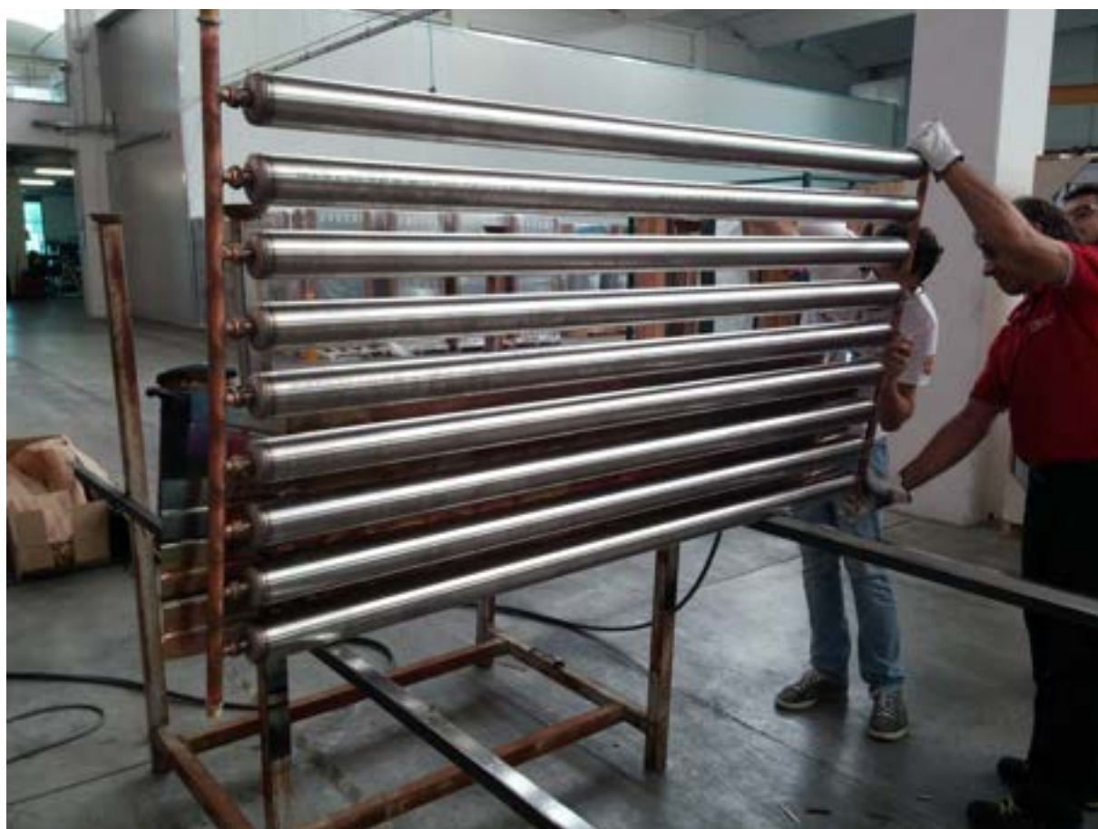
Fig. 26 – Assemblaggio del pannello solare con i tubi innovativi.
