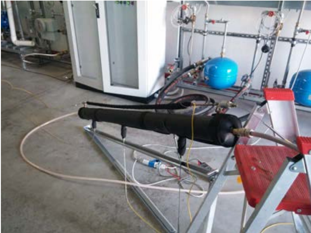
Fig. 18 – Foto del dispositivo per prove effettuate su tubo singolo.
