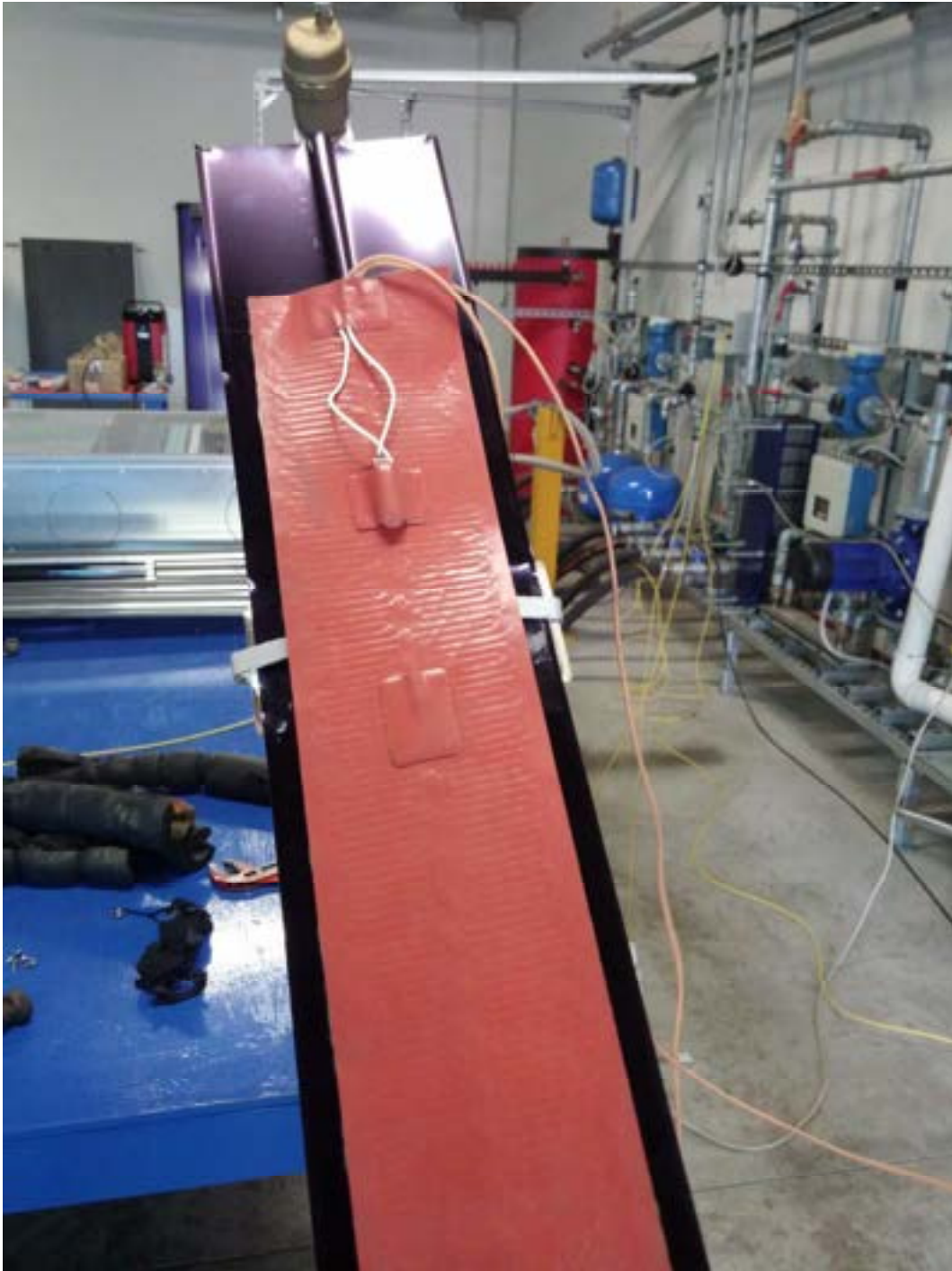
Fig. 65 – Nuova disposizione del riscaldatore per le prove con vapor chamber, particolare.
