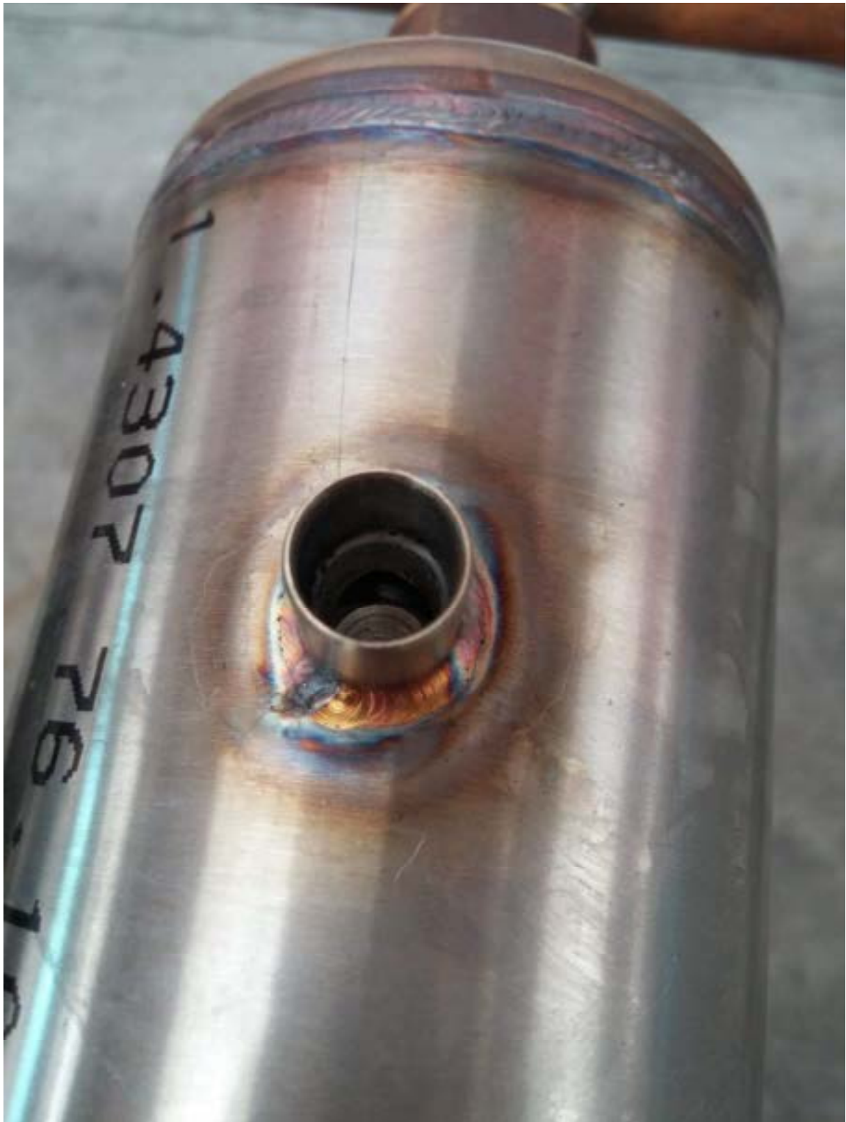
Fig. 25 – Immagine ingrandita dell'attacco fra tubo ricevitore e serbatoio sottostante.
