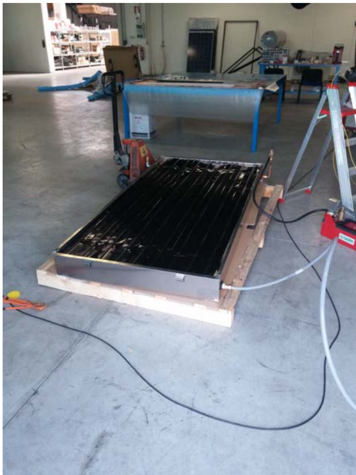
Fig. 35 – Pannello solare assemblato (lato anteriore). Prime prove idrauliche.
