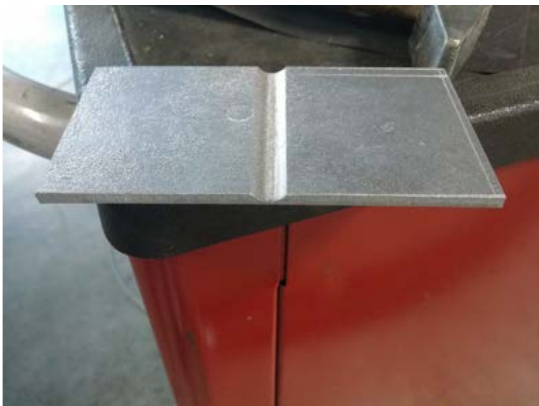
Fig. 66 – Piastra usata per il fissaggio della vapor chamber
