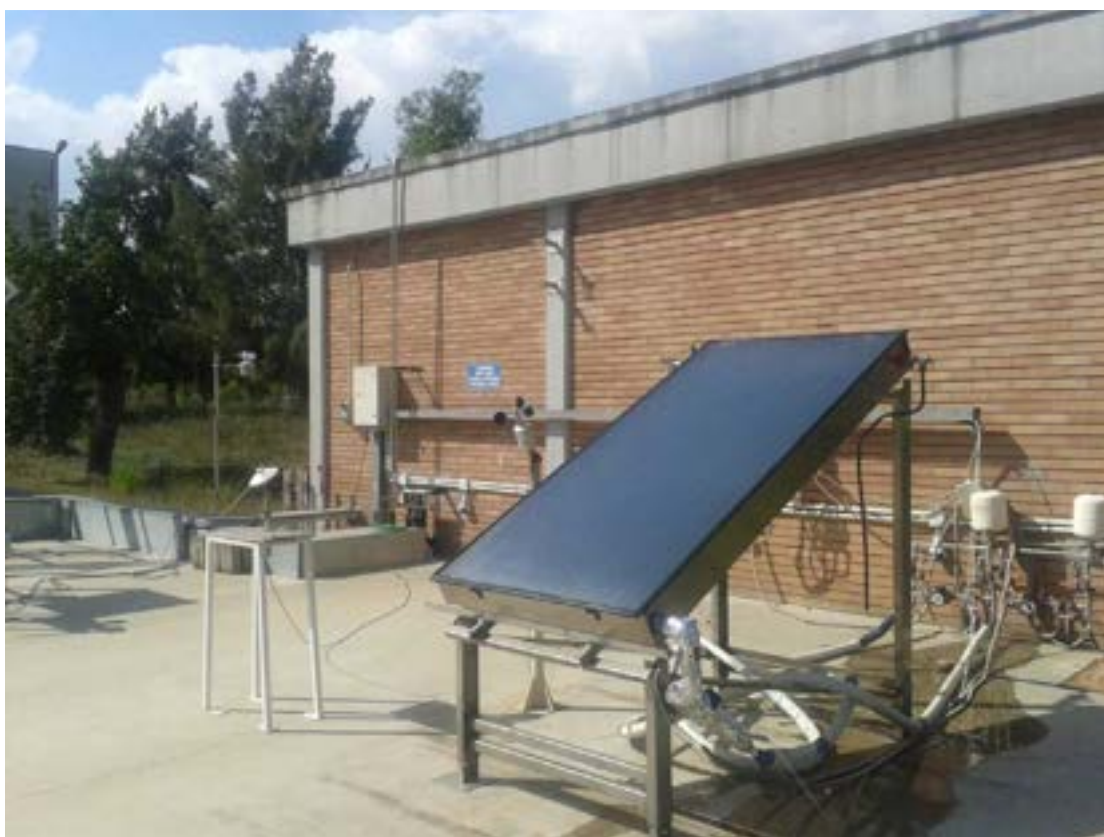
Fig. 94 – Foto del pannello solare innovativo in prova, vista laterale.
