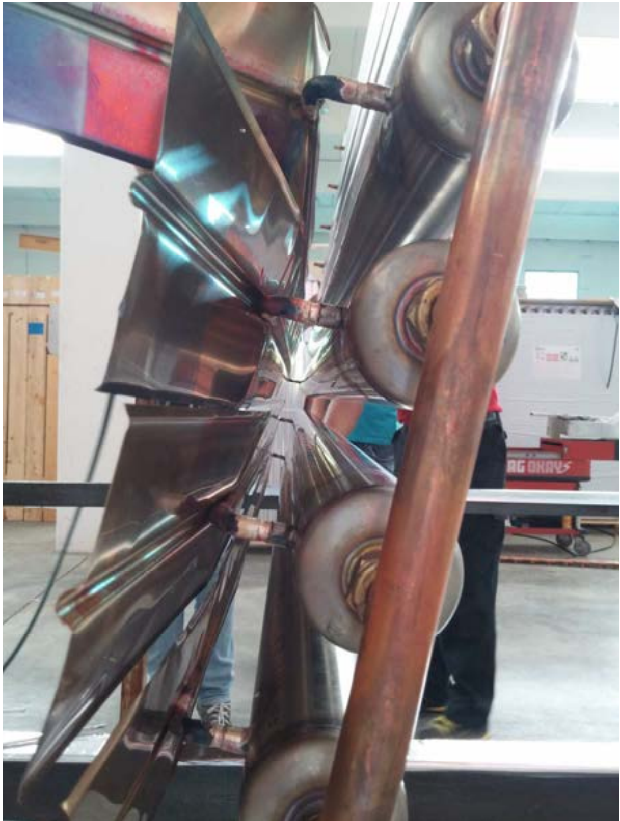
Fig. 27 – Particolare dell'accoppiamento fra piastra assorbitrice e tubo ricevitore.
