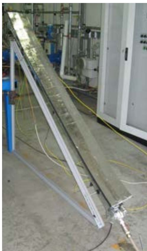
Figura 5.17 – Modulo del collettore durante la prova sperimentale (senza vapor chamber e con isolamento sopra la piastra).
