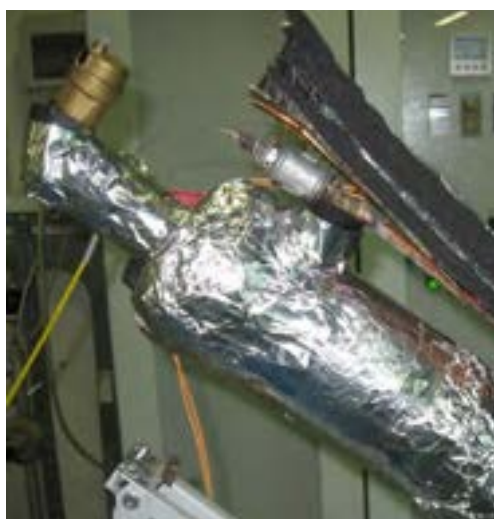
Figura 5.19 – Zoom sull’isolamento della piastra durante la prova sperimentale.
