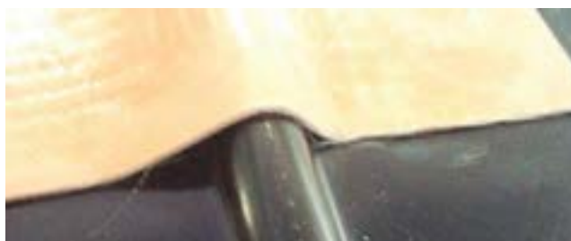
Figura 5.14 – Spazi d'aria che si creano tra piastra e resistenza elettrica a striscia.
