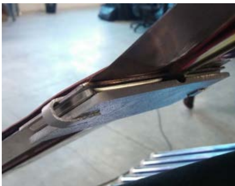
Figura 5.18 – Applicazione della vapor chamber prima dell'applicazione dell'isolamento.
