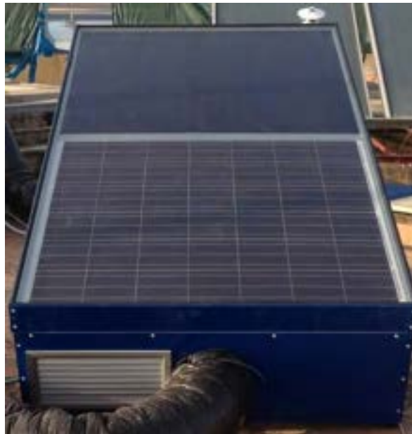
Figura 5: Collettore solare ibrido termico fotovoltaico
