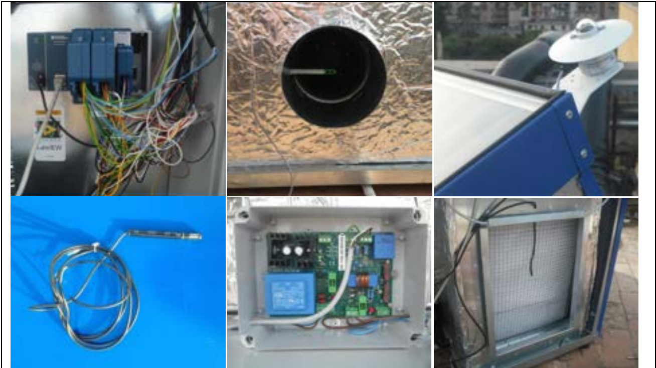
Figura 15: Foto di alcune parti dell'unità di acquisizione e controllo NI cDAQ 9184 e di alcune parti della strumentazione di misura utilizzata
