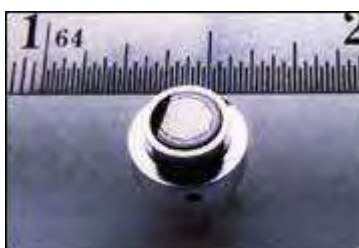
Figura 54: Sensore HFM della Vatell
