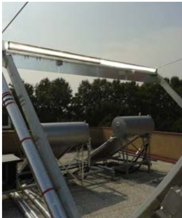
Figura 2 - Ricevitore a minicanali per la produzione di calore a media temperatura. In alto: dettaglio della parte frontale. In basso: ricevitore installato sul concentratore durante un test presso il Laboratorio di Conversione dell'Energia Solare dell'Università di Padova.
