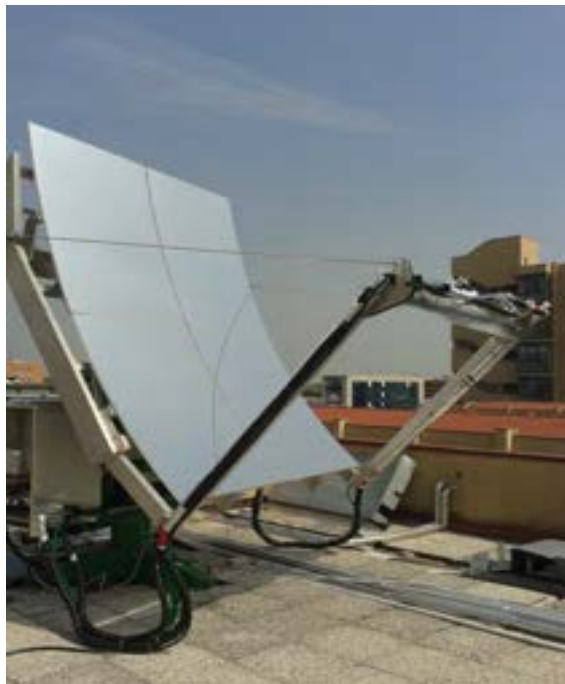
Figura 3 - Concentratore a specchi parabolici a fuoco lineare presso il Laboratorio di Conversione dell'Energia Solare dell'Università degli Studi di Padova.
