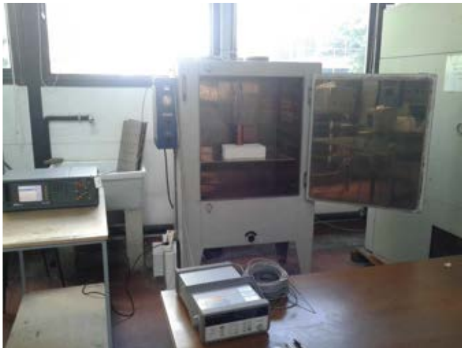
Figura 5 - Sistema di calibrazione delle termoresistenze del circuito primario presso il Dipartimento di Ingegneria Industriale.
