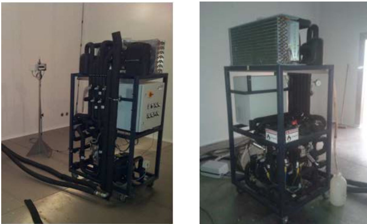
Figura 16. I due prototipi installati in camera climatica (a destra la macchina a R290)
