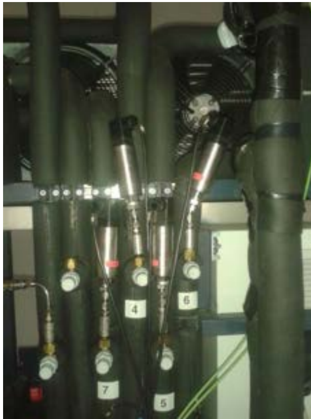
Figura 19. Misuratori di pressione GE Druck PTX montati sulla macchina in prova
