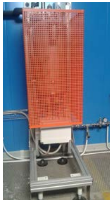
Figura 3. Gruppo Frigorifero e generatore di vapore a servizio della Camera Climatica
