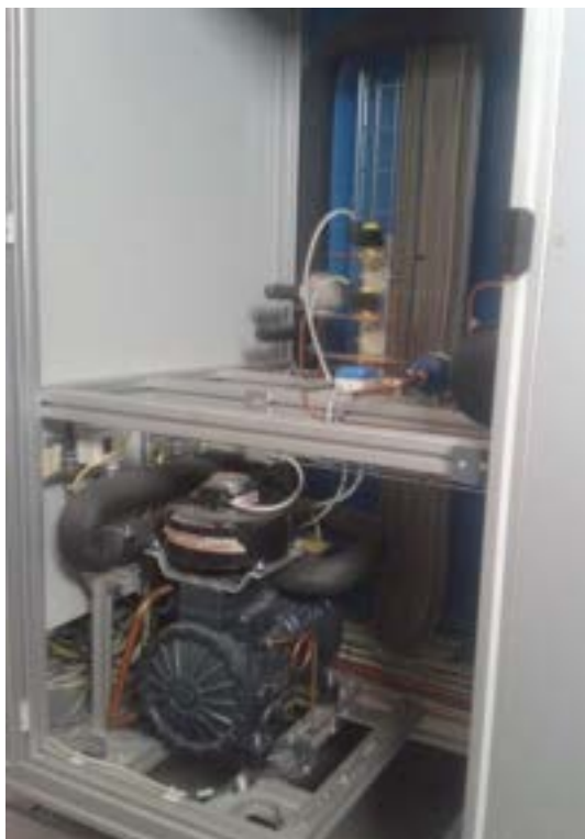
Figura 3. Gruppo Frigorifero e generatore di vapore a servizio della Camera Climatica
