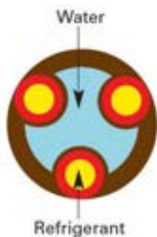
Figura 22. Sezione trasversale dello scambiatore ad acqua (gas cooler).
