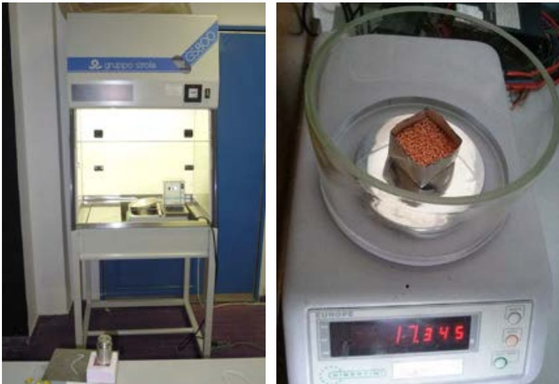
Figura 6 – a) Cappa con all’interno il bagno termostato; b) blocchetto di schiuma nel contenitore in “coffee bag”, sulla bilancia
