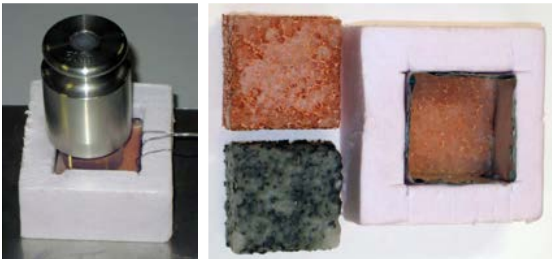
Figura 7 – a) blocchetto durante il raffreddamento dopo il riempimento con PCM; b) blocchetti di schiuma riempiti di PCM: in alto Cu-10, in basso SiC, a destra Cu-10 nel contenitore.
