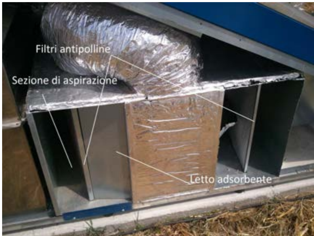
1.3 Aspirazione - Filtro - Letto adsorbente
