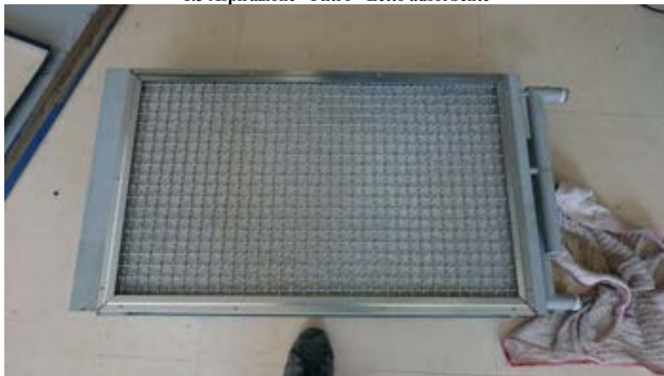
1.4 Letto adsorbente e tubi di raffreddamento alettati
