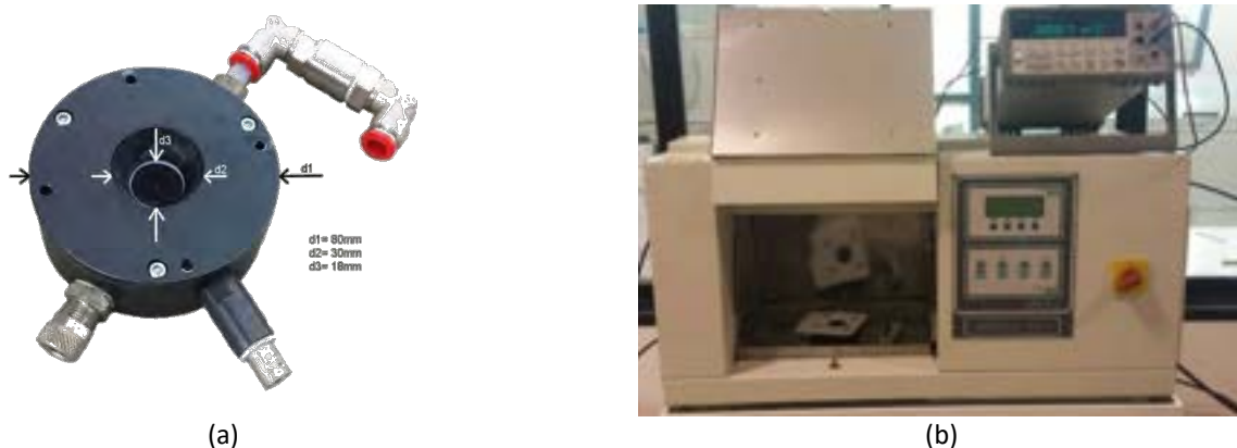
Figura 15: a) Sensore a termopila utilizzato nella fase preliminare di messa a punto della metodica di misura della radiazione concentrata; b) Caratterizzazione del sensore a termopila mediante misure di tensione effettuate in corrispondenza di flussi di radiazione crescenti e generati mediante una SolarBox.
