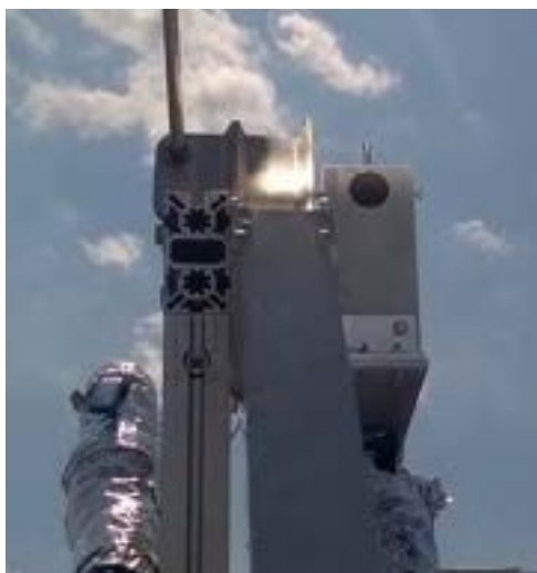
Figura 29 – Particolare del sensore montato sulla testa dello slider verticale (asse z ).
