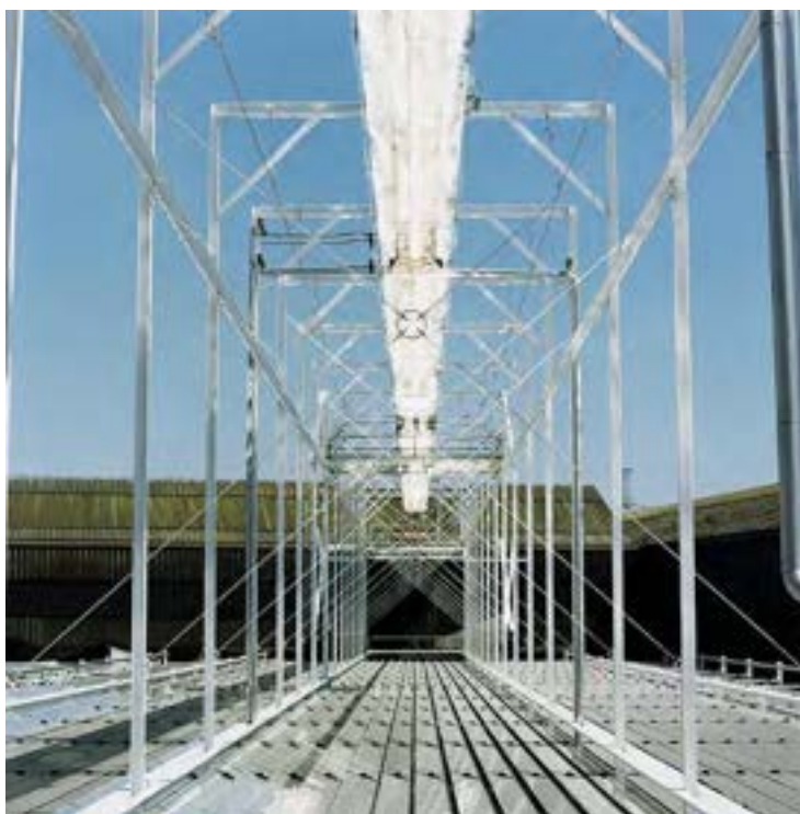
Figura 6 – Ricevitore e ottica secondaria in un sistema a concentrazione lineare Fresnel (Häberle et al. 2002).
