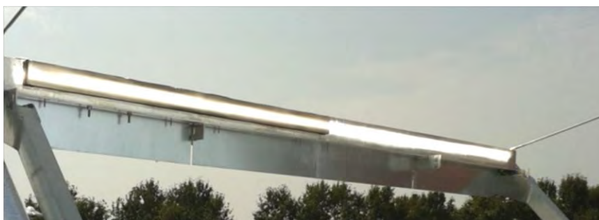
Figura 28 – Particolare della regione di concentrazione della radiazione riflessa (Bortolato et al. 2014).
