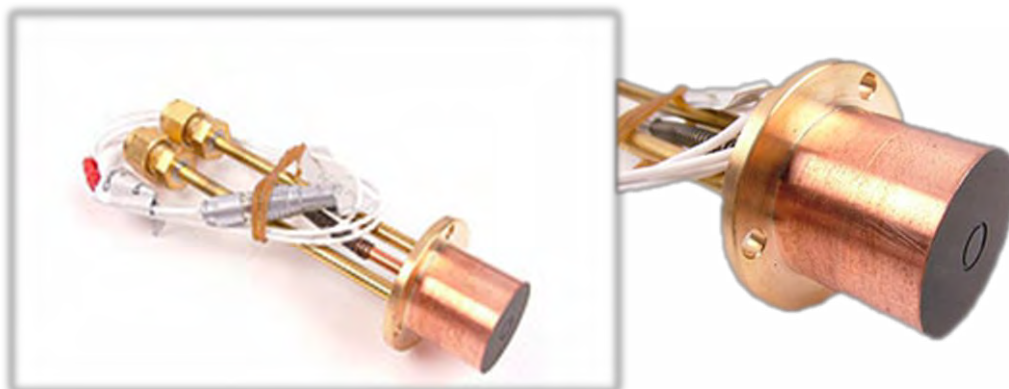
Figura 31 - Sensore di flusso termico Vatell HFM-7E/L con corpo di raffreddamento in rame (Vatell Corporation 2015).
