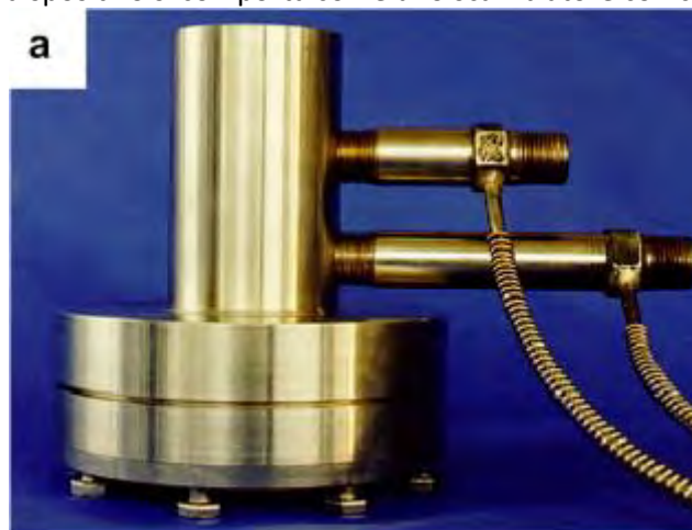
Figura 17 - Calorimetro con ricevitore a piastra presentato da Estrada et al. (2007).
