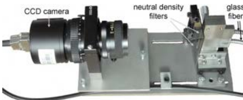
Figura 23 – Camera CCD accoppiata con il fascio di fibre ottiche proveniente dalla seconda versione del sistema PARASCAN . (Schiricke et al. 2009)
