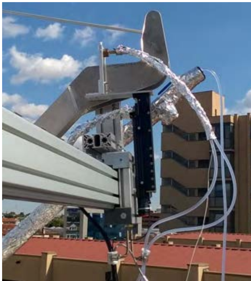
Figura 27 – Sistema di movimentazione del sensore e collegamenti del circuito di raffreddamento del sensore.
