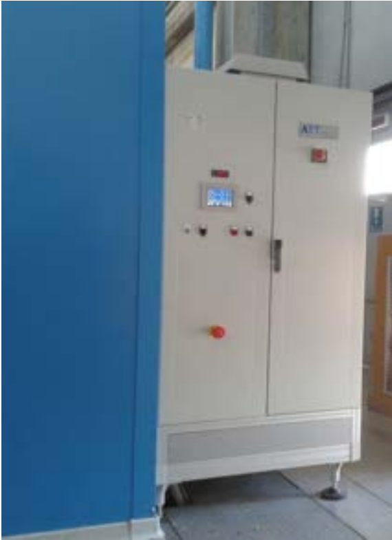
Figura 9. Quadro elettrico con pannello di controllo Touch Screen della camera climatica e sensori di temperatura e umidità alloggiati all'interno della stessa
