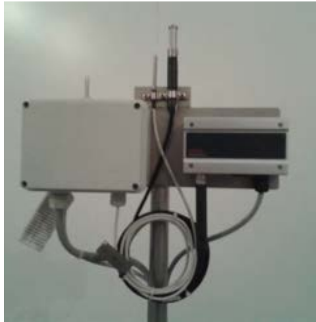
Figura 9. Quadro elettrico con pannello di controllo Touch Screen della camera climatica e sensori di temperatura e umidità alloggiati all'interno della stessa
