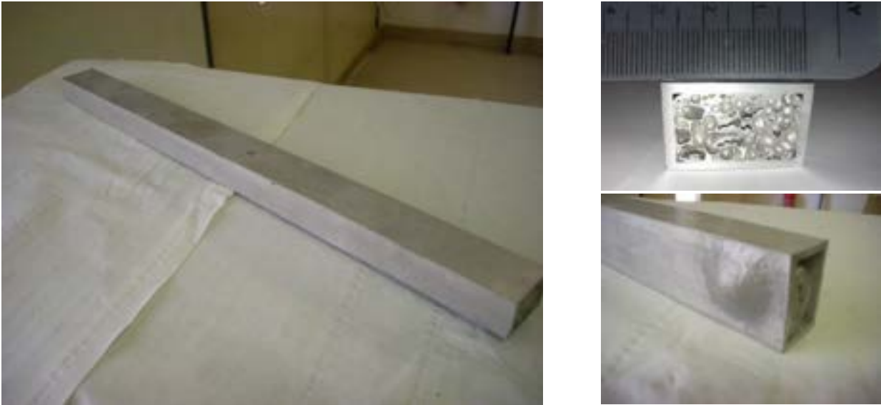
Figura 73: Profilato estruso di lunghezza 400 mm con evidenza della zona di collasso per eccessiva vicinanza alla parete posteriore del forno
