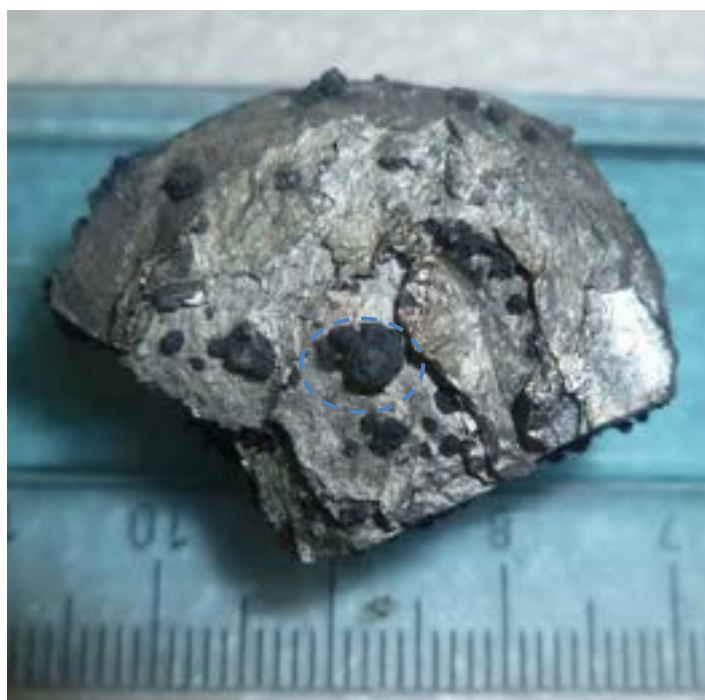
Figura 53: Campione 13 schiumato con fuori estrusi scuri in superficie
