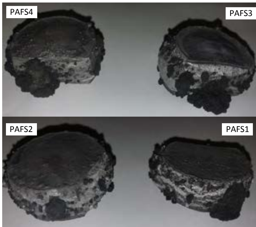
Figura 61: Campioni schiumati di precursori composti con pelli di alluminio di spessore 1,5 +/- 0,2 mm
