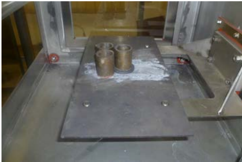
Figura 50: Set Up per schiumatura dei precursori Eutettici ENEA
