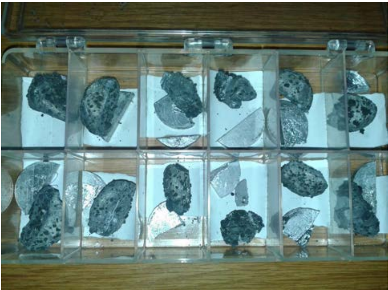
Figura 51: Risultati di schiumatura dei precursori eutettici sviluppati
