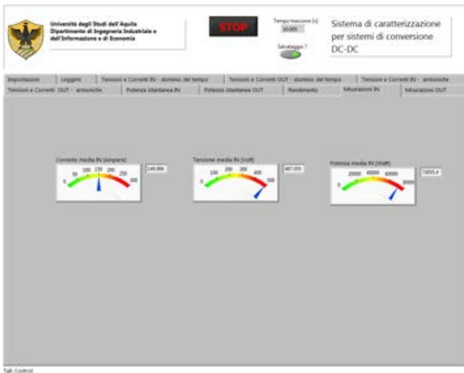
Fig. 28– Pagina “Misurazioni IN” del Sistema di caratterizzazione in linea per sistemi di conversione DC/DC
