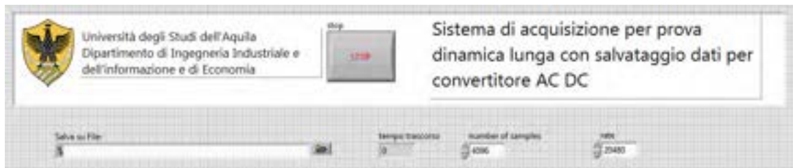
Fig. 65 : Front panel del sistema di acquisizione di lunga durata per conversione AC/DC
