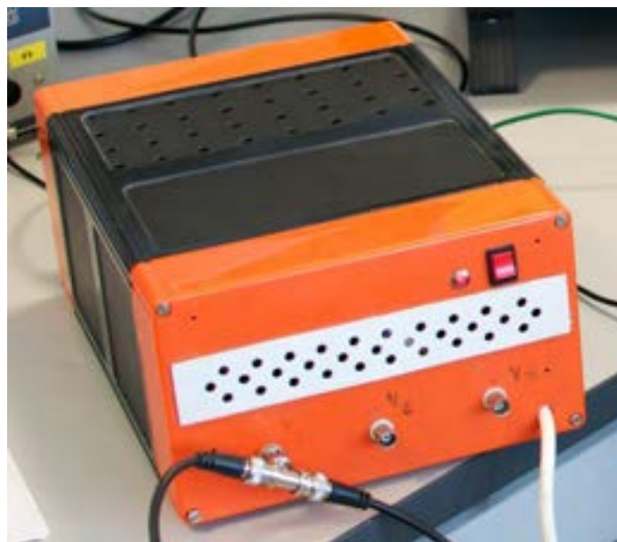
Fig.13– Blocco di misura tensioni trifase lato AC
