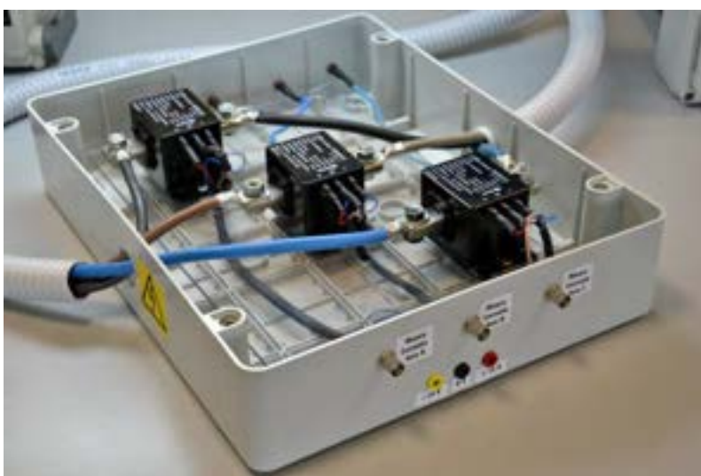
Fig. 16- Blocco di misura delle correnti AC trifase, con connettori BNC e boccole per l'alimentazione.
