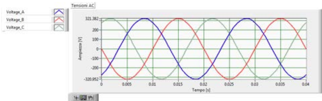
Fig.120 – Forme d’onda di tensione AC nel dominio del tempo, con sistema di conversione a vuoto
